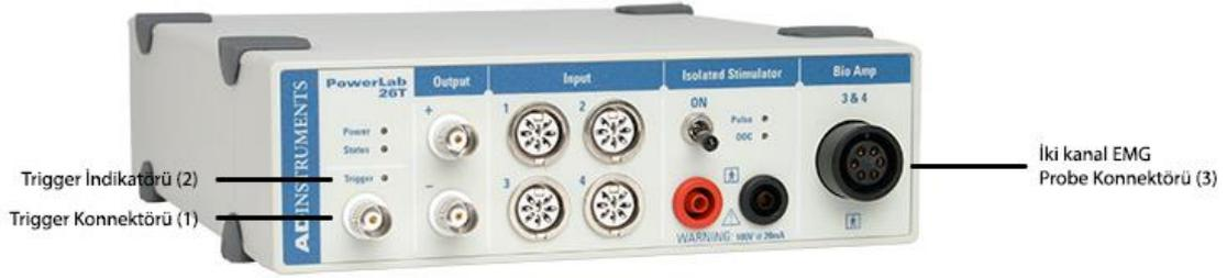
Şekil 2 - EMG Cihazı Bağlantı Şeması
