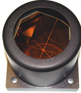
Şekil 4. Ay'daki ayna sisteminin bir yansıtıcı bölümü
