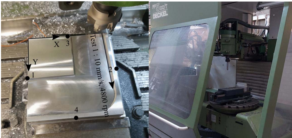
Şekil 3. İş parçası ivmeölçer pozisyonları (1-3), çekiç testi vuruş pozisyonları (2-4) ve test parametreleri. (Workpiece accelerometer positions (1-3), hammer test tap spots (2-4) and test parameters)
