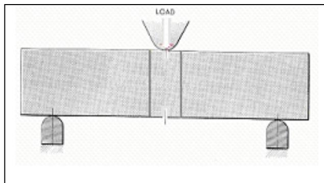
Fig. 6.8: Nick-Break Test
