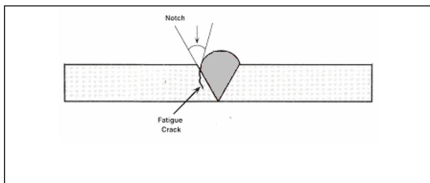
Fig. 2.8: Fatigue Crack
