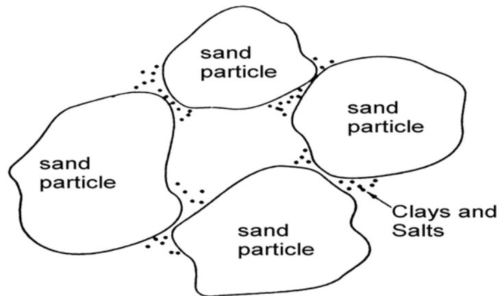
**Figure 2.3.** Forming of Collapsible Soils (Coduto, 1994)
