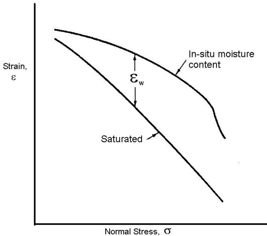
**Figure 2.5.** Double Oedometer Test Results (Coduto, 1994)
