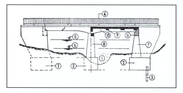
**Figure B.9** 1.undermining 2.foundation 3.pile 4.slab 5.low water level 6.high water level 7.abutment 8.pier 9.horizontal beam 10.longtituinal beam 11.hinge Source: Köylüoğlu, A., "Karayolu Köprüleri", Tarım ve Köy İşleri Bakanlığı YSE Genel Müdürlüğü Yayın No.131, Ankara, 1973, p.86
