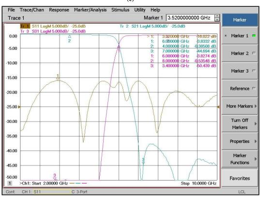
(d) Figure 4. 17 (continued) (c) 6 GHz diplexer module (d) Its response
