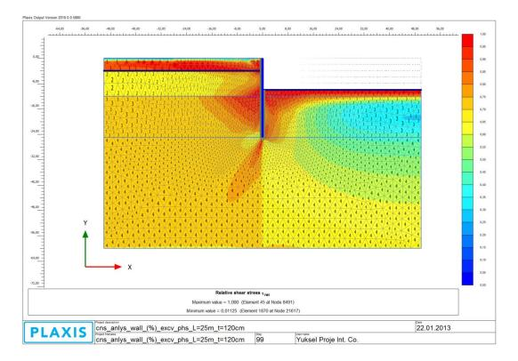
Figure B 16: Relative Shear Stress (**trel**) (Step 7)
