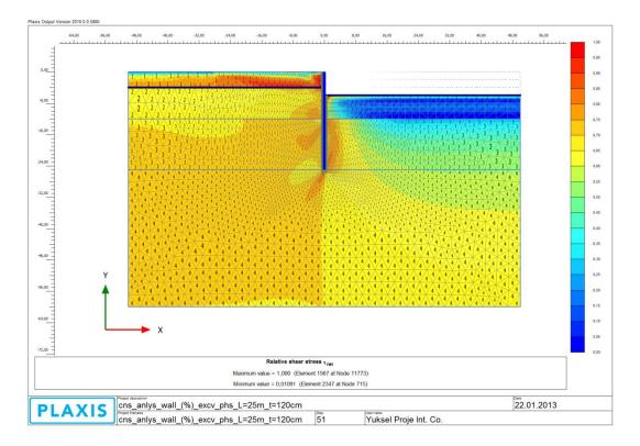
Figure B 10: Relative Shear Stress (**trel**) (Step 5)
