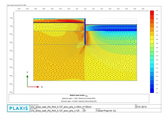
Figure B 26: Relative Shear Stress (**trel**) (Step 5)
