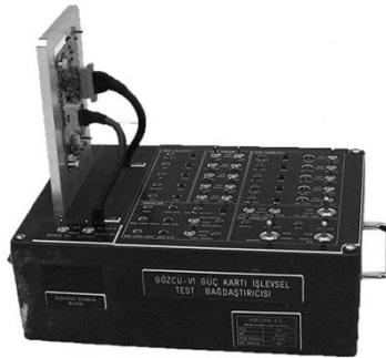
Resim-1 – Test Kutusu Kart Yerleşimi
