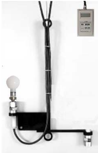
Figure 3.4: PAR Sensor Equipment (Atiker, 2011)
