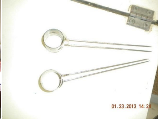
Figure 3.11. Le Chatelier Apparatus
