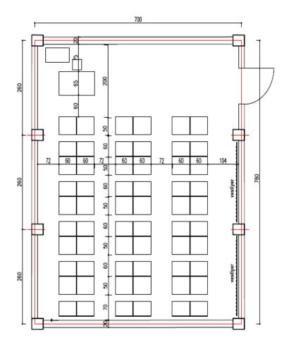
**Figure 3.1** Architectural Drawing of a Typical Classroom ("Eğitim Yapıları Mimari Proje Hazırlanması Genel İlkeleri")
