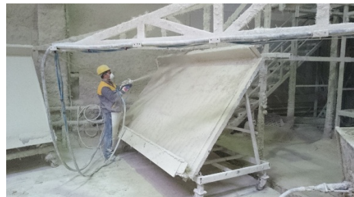
(d) Spraying procedure and the mold
