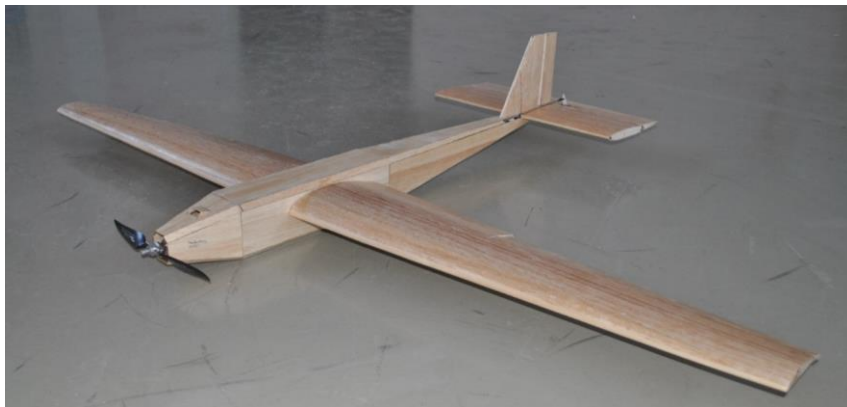
Figure 4.1. HUAVN Composite Mini UAV [41], [42]
