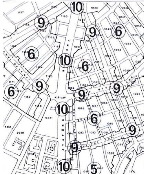
Figure 22 Ankara district building height plan Source: Sezai Göksu, “Yenişehir: Ankara’da Bir İmar Öyküsü,” in Kent, Planlama, Politika, Sanat: Tarık Okyay Anısına Yazılar , ed. İlhan Tekeli (Ankara: Mimarlık Fakültesi, 1994), 275.
