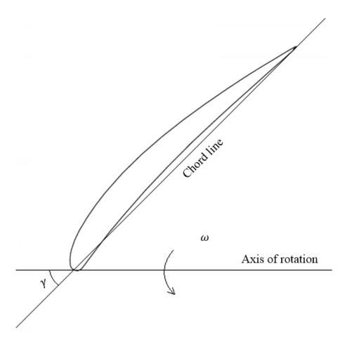
Figure 2.12. Stagger Angle
