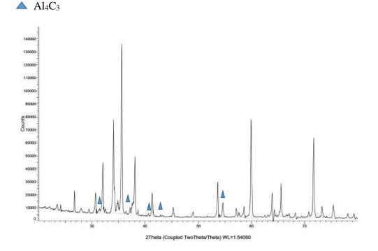
Figure 5.11. XRD analysis of sintered 80S10B10A
