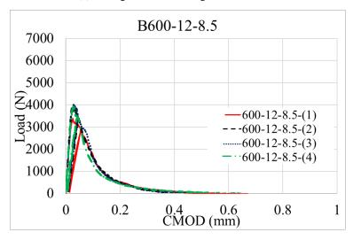
(d) 600 kg/m<sup>3</sup> binder dosage RCC mixture
