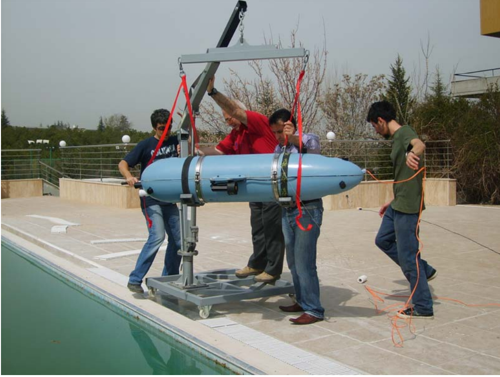
Şekil 3.0.10 Denizaltıyı vinç ile havuz kenarına yaklaştırma işlemi
