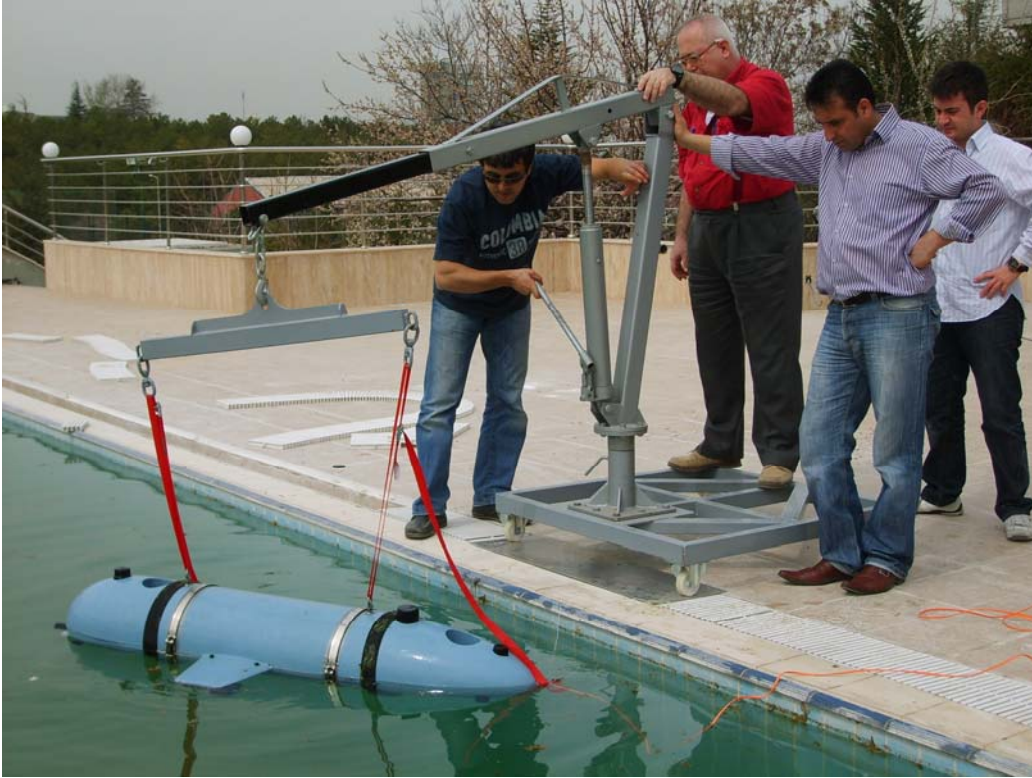
Şekil 3.0.11 Denizaltıyı vinç ile havuza indirme işlemi
