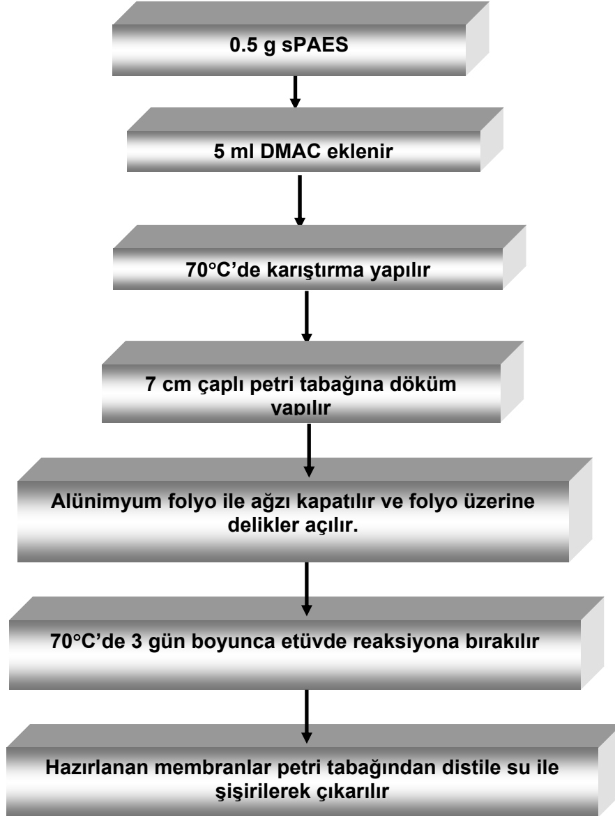
Şekil 14 sPAES membran için membran hazırlama reçetesi
