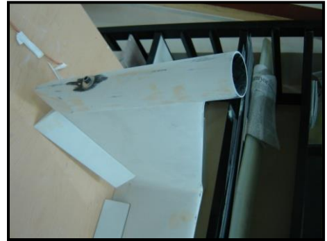
Şekil E-111 Boru ve Yatak Arasındaki Vida bağlantısı
