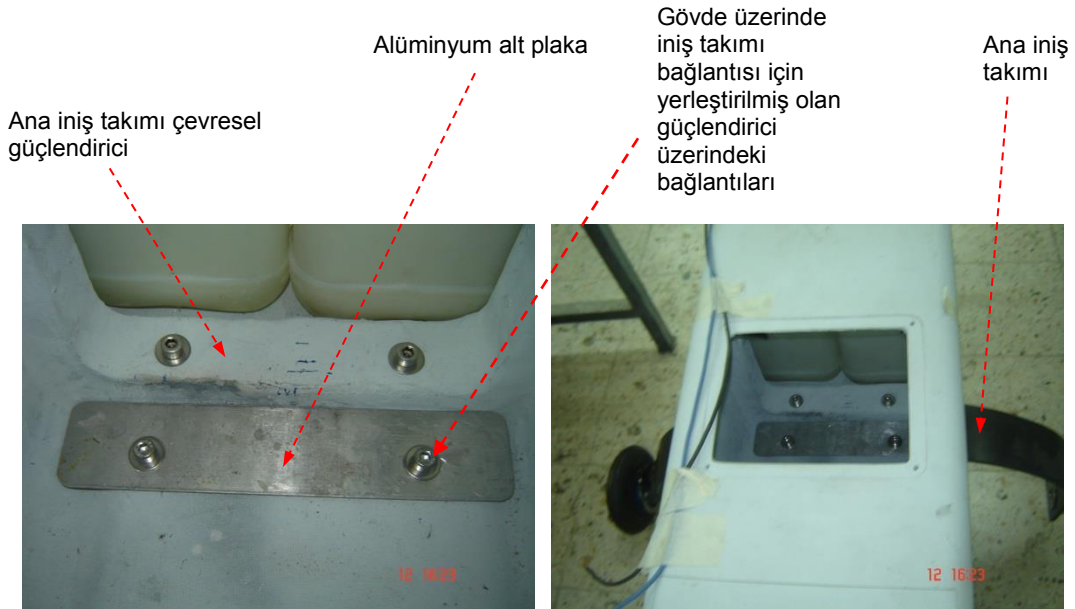
Şekil C1.16 Ana iniş takımının gövde bağlantısının yapıldığı noktalar
