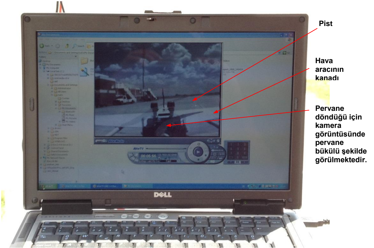
Şekil 6.5 Hava aracının yatay kuyruk düzlemine yerleştirilen kameradan alınan gerçek zamanlı video görüntüsü
