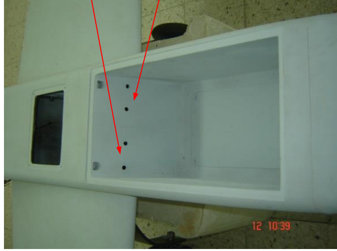
Şekil C1.14 Kanadın yerleştirilmesinden sonra kiriş kutusu üzerinde bağlantı vidaları için açılmış olan deliklerin paraşüt kapağı tarafından olan görüntüsü
