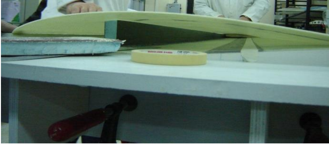
Şekil E-17 Kanat üst yüzeyi ile kirişler arasında yapıştırıcı kalınlığı kadar boşluk bırakma işlemi
