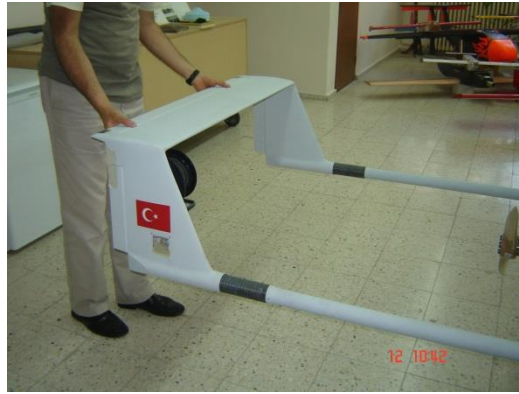
Şekil C1.26 Kuyruk düzleminin kanat-kuyruk bağlantı borularına geçirilmesi
