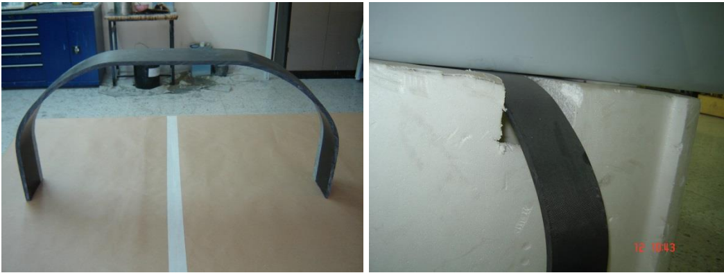
Şekil C1.15 Karbon kompozit malzemeden yapılmış olan ana iniş takımı ve gövde bağlantısı
