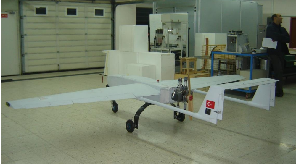
Şekil C1.60 Yapısal ve elektromekanik bütünleştirme çalışmaları tamamlanmış insansız hava aracı
