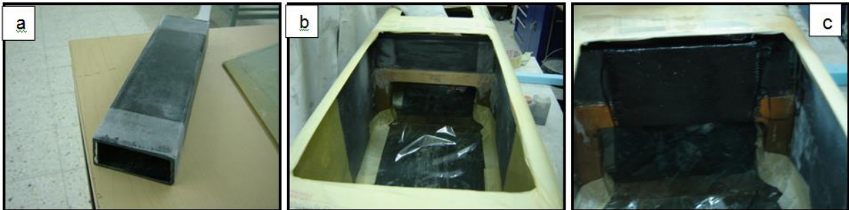
Şekil E-76 Kanat ön kiriş kutusu ve yerleştirilmesi
