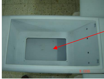
Şekil C1.7 Hava aracı üzerindeki kamera/gimbal sistemi montajı için ayrılmış olan alt bölme
