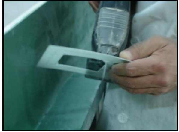
Şekil E-63 Erkek kalıp üzerine cam elyaf serimi (solda) Çıkan katmanların elle kesilerek çevre haline getirilmesi (sağda)
