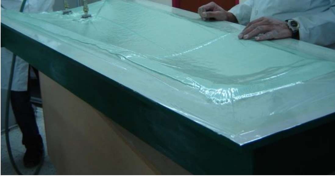
Şekil E-12 Vakum işlemi sırasında Kanat üst yüzeyi
