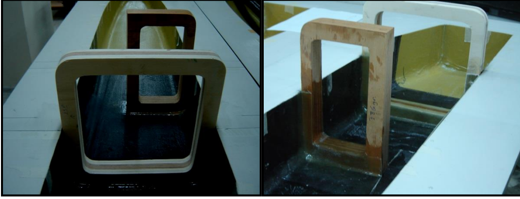
Şekil C1.9 Gövde içindeki ana taşıyıcı iskeletler
