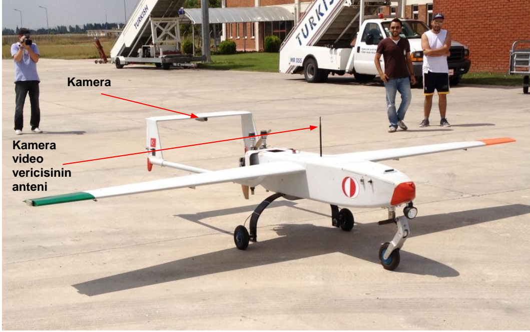
Şekil 6.4 Hava aracının yatay kuyruk düzlemine yerleştirilen kamera ve verici anteni
