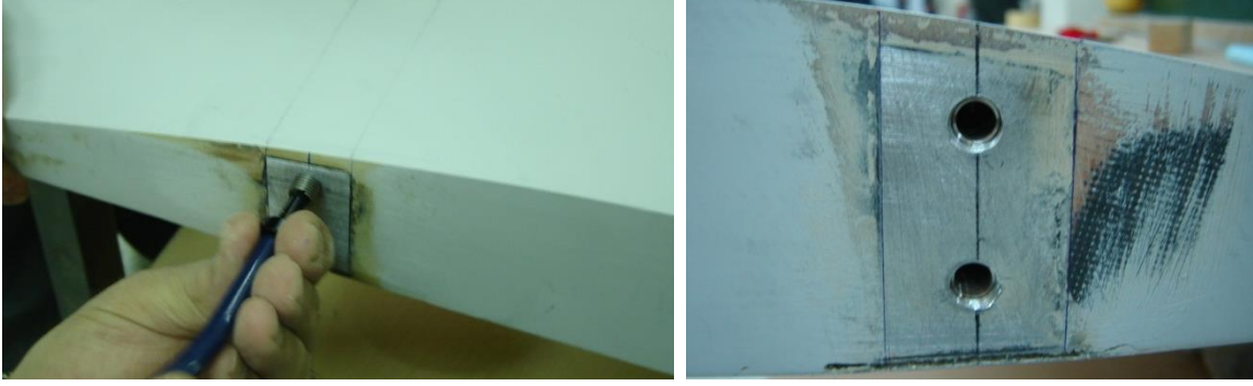
Şekil E-52 Delik açma ve helicoil yerleřtirme (solda), işlemler sonrasında arka kiriřteki cıvata yuvaları (saęda)
