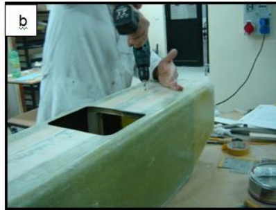
Şekil E-74 Gövdenin kalıptan çıkması gövde kapısının ve bazı kapaklarının kesilmesi
