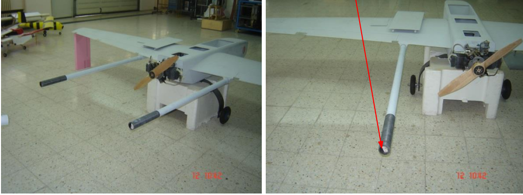
Şekil C1.25 Kanat üzerine takılmış olan kuyruk boruları
