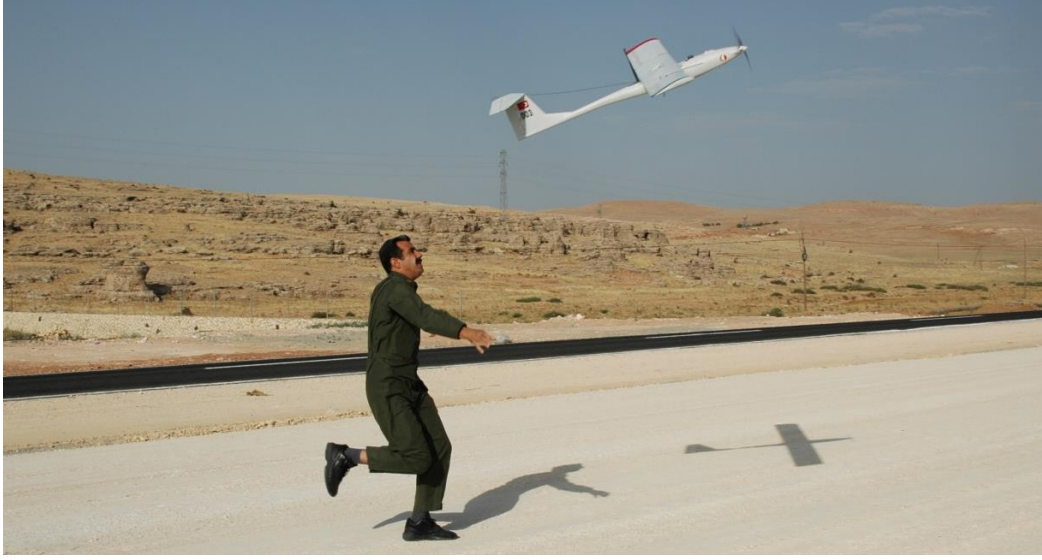
Şekil 7.4 Güventürk mini insansız hava aracının kalkışı – elle fırlatılarak
