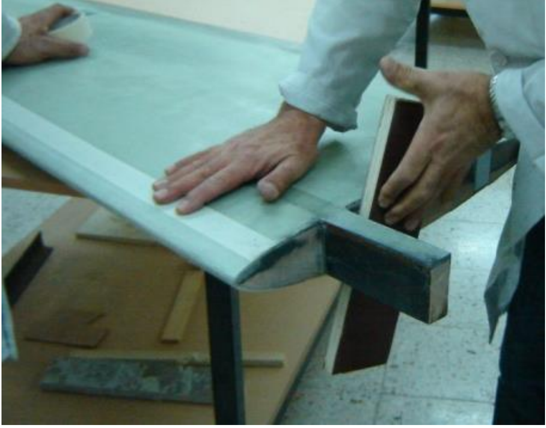
Şekil E-45 Kanat kökündeki sinirin zımparalanarak pürüzsüz hale getirilmesi
