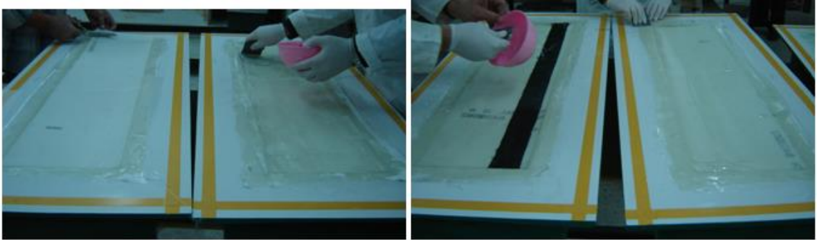
Şekil E-88 Yatay Kuyruk Kompozit Katmanlarının Yerleştirilmesi Ve Alt Yüzeye Karbon Fiber Şeridin Eklenmesi
