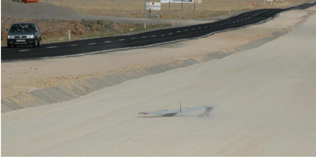
Şekil 7.7 Güventürk mini insansız hava aracının inişi – gövde üzerine
