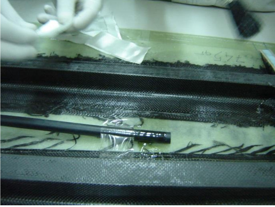
Şekil E-36 Kablo borularının kanat alt yüzeyine sabitlenmesi
