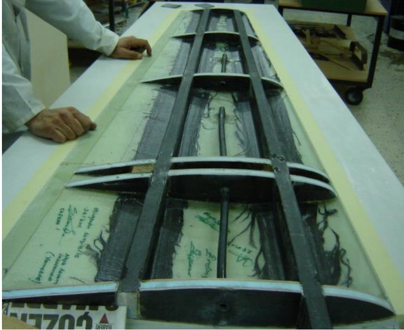
Şekil E-37 Kanat alt yüzeyinin üst yüzey ile birleştirilmeye hazır son halı
