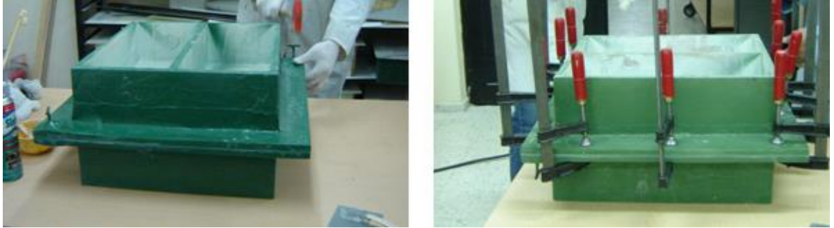
Şekil E-101 Dikey Kuyruk Kalıplarının Ters Çevrilip İşkencelerle Sıkılması Ve Yapıştırıcının Donmaya Bırakılması
