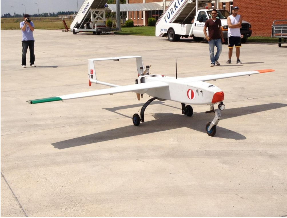
Şekil D.2 Bütün sistem entegrasyonu tamamlanmış olan insansız hava aracı
