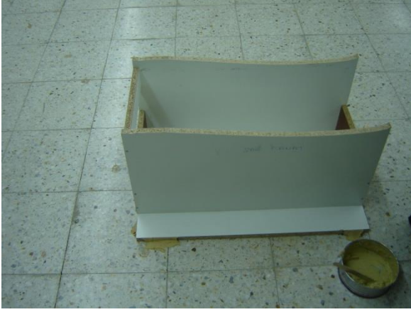
Şekil E-47 Kanat köklerinin oturtulacağı tahta kalıp (solda), kanatların kirişleri ucuca getirilmiş hali (sağda)
