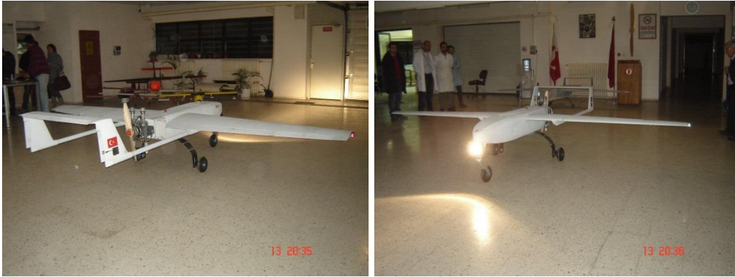
Şekil C1.59 Taktik insansız hava aracının kanat ucundaki sabit ve çakar ışıkları
