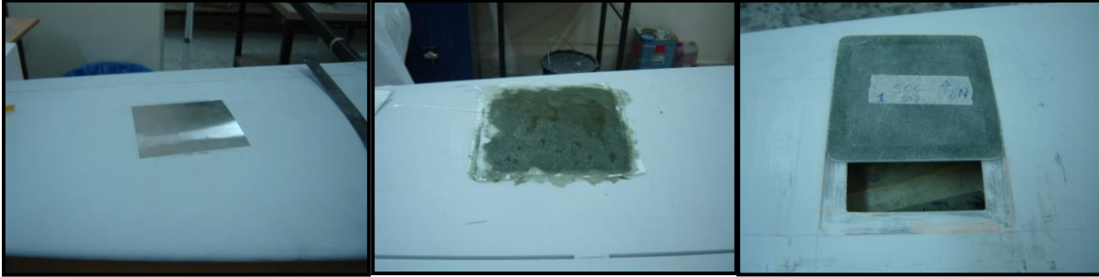
Şekil E-65 Servo yuvası üstüne ince metal plaka yapıştırılması (solda) kompozit katların uygulanması (ortada) çıkan katların trimlenerek kapak haline getirilmesi (sağda)
