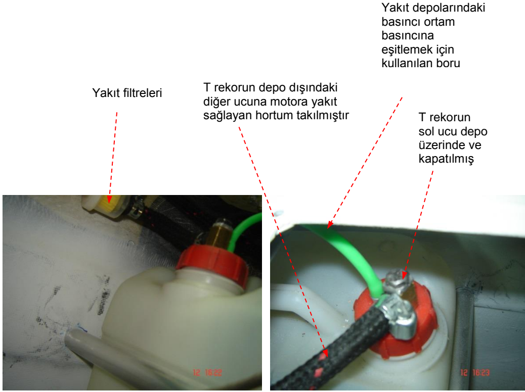
Şekil C1.22 Yakıt depolarının gövde içindeki yakın görüntüleri
