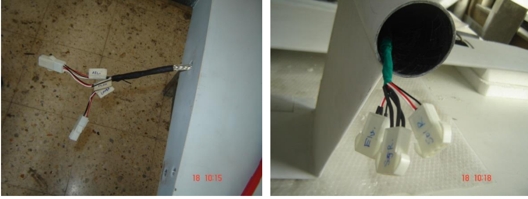
Şekil C1.53 Kanatta yer alan kanatçık, “flap” ve sabit ve çakar lamba kabloları kanadın kök sınırından çıkartılmış
