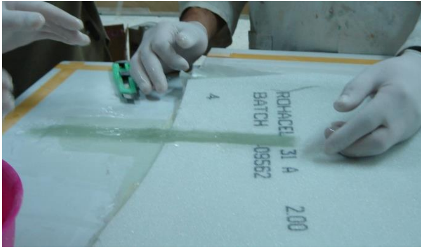
Şekil E-4 Kanat Kökündeki Rohacell'li Kiriş Girişinin Trimlenmesi ve Yerine Elyaf Yerleştirilmesi.
