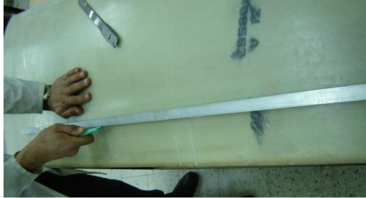
Şekil E-53 Kontrol yüzeylerinin kanattan kesim işlemi
