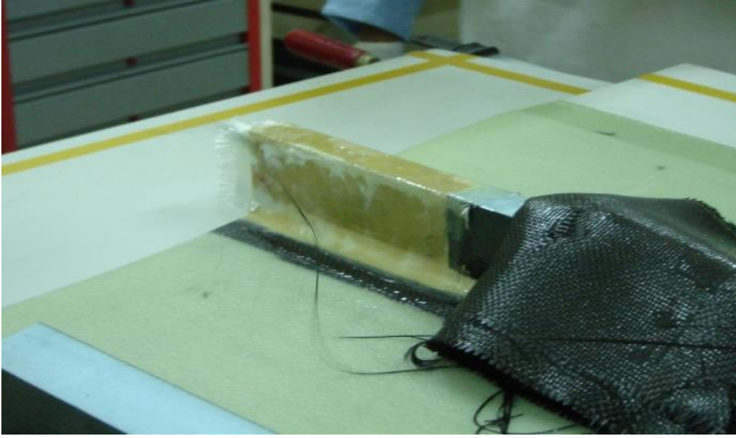
Şekil E-20 Alüminyum blok üzerine serilen ince cam elyaf-reçine katmanı
