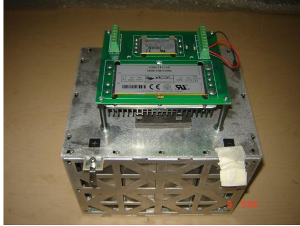
Şekil C1.6 5V ve 12 V DC-DC çeviriciler ile bütünleşik hale getirilmiş olan 4S-15P Li-Po batarya bloğu ve alimünyum kasası
