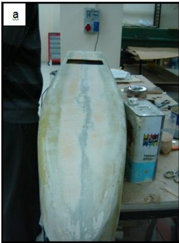
Şekil E-74 Gövdenin kalıptan çıkması gövde kapısının ve bazı kapaklarının kesilmesi
