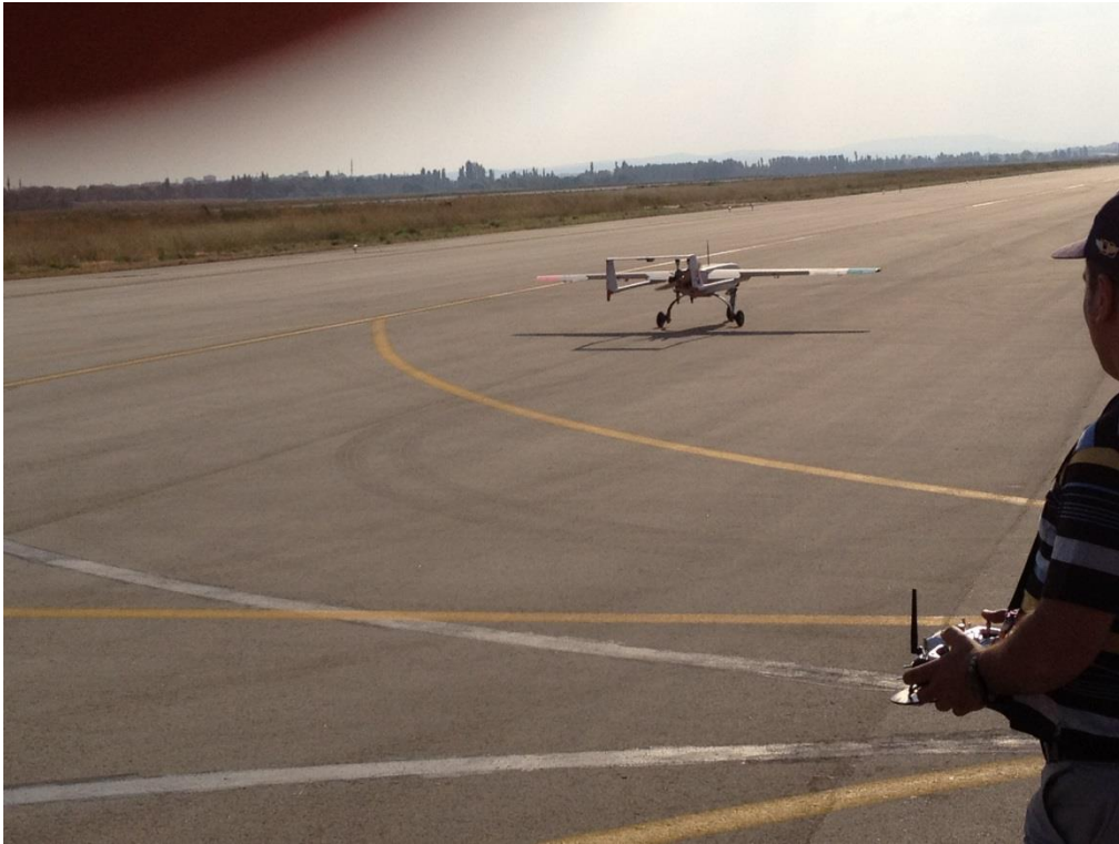
Şekil D.3 Pistte gerçekleştirilen taksi testleri -1
