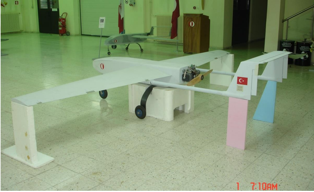
Şekil C1.2 Kanat, kuyruk düzlemi, ön ve arka iniş takımları ve motoru bir araya getirilmiş hava aracı-yan/arka görüntü
