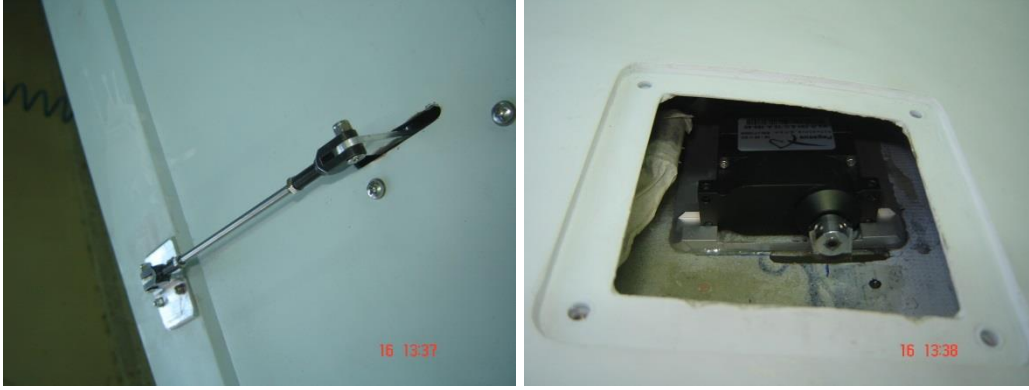
Şekil C1.45 “Flap” hareketi için kanada takılan PA-R-250-8 servo motoru, yekesi, servo kolu ve ara bağlantı çubuğu ve kafasının yakın görüntüsü
