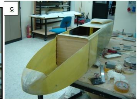
Şekil E-74 Gövdenin kalıptan çıkması gövde kapısının ve bazı kapaklarının kesilmesi
