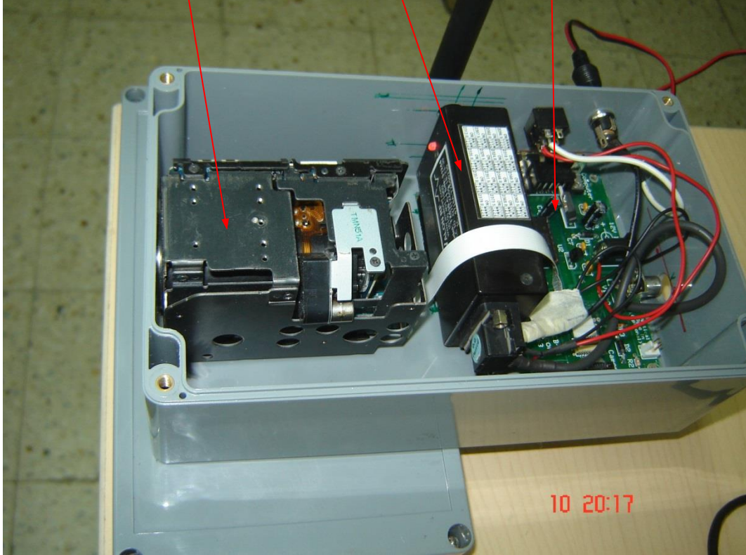
Şekil C2.2 Görüntü aktarım sisteminin hava aracı tarafı- kamera, iletişim kontrol kartı ve verici
