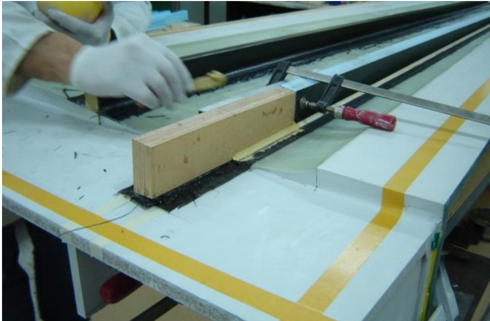
Şekil E-23 Kanat ön kirişine yerleştirilen gürgen blok
