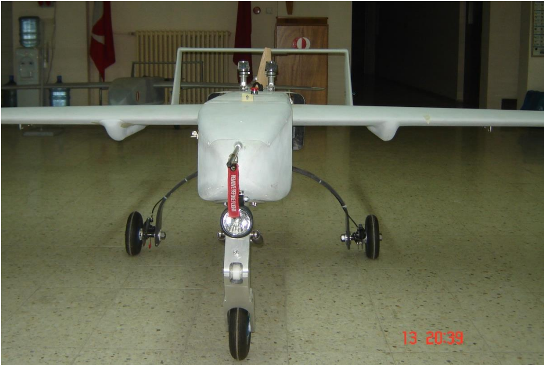
Şekil C1.61 Kanat, kuyruk düzlemi, ön ve arka iniş takımları ve motoru bir araya getirilmiş hava aracı-ön görüntü
