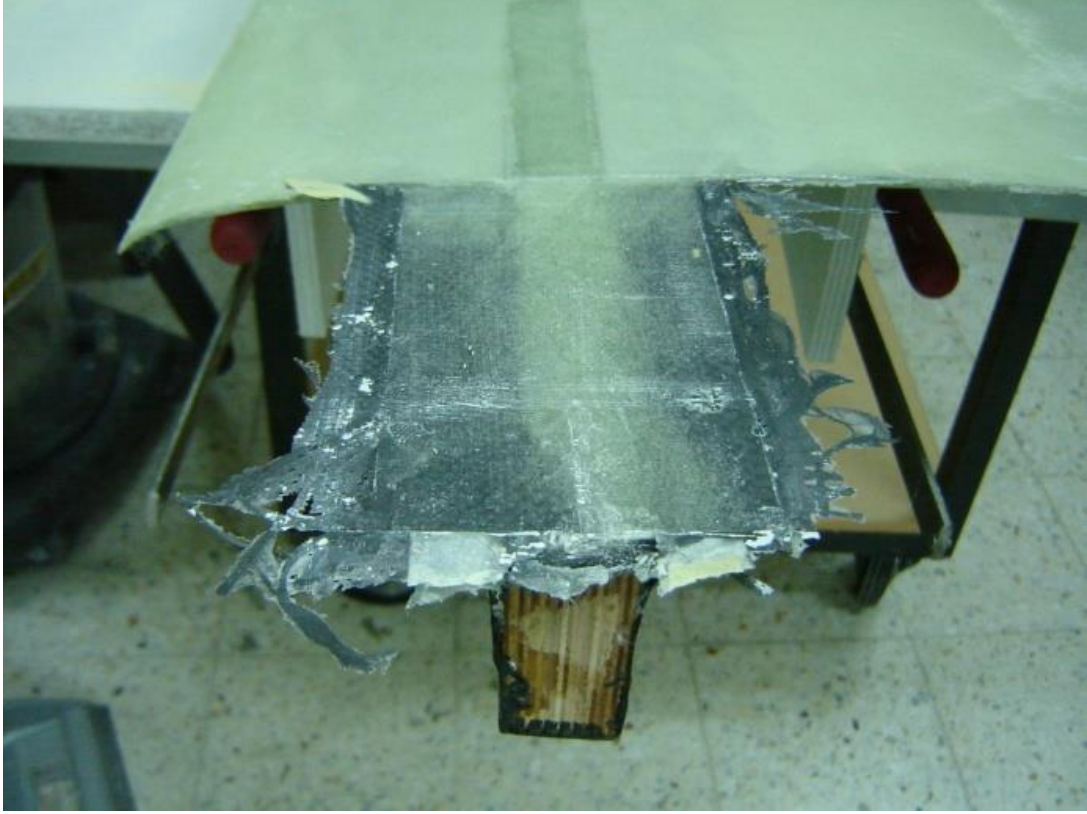
Şekil E-26 Ön kirişin gövdeye gireceği kısımda işlem sonrasında oluşan fazlalıklar
