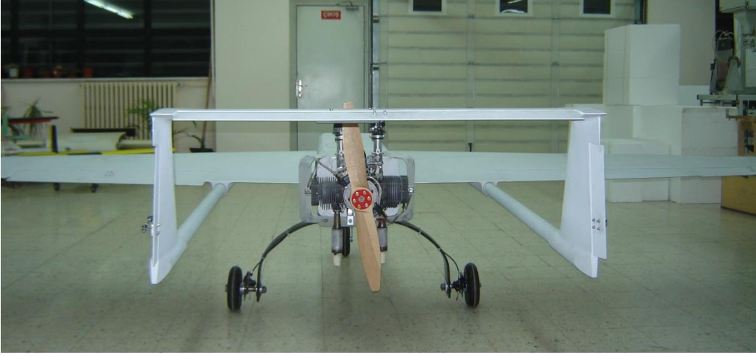
Şekil C1.62 Kanat, kuyruk düzlemi, ön ve arka iniş takımları ve motoru bir araya getirilmiş hava aracı-Arka görüntü
