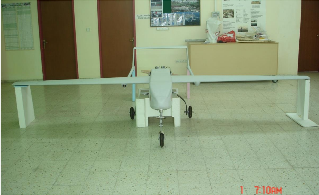
Şekil C1.3 Kanat, kuyruk düzlemi, ön ve arka iniş takımları ve motoru bir araya getirilmiş hava aracı-ön görüntü
