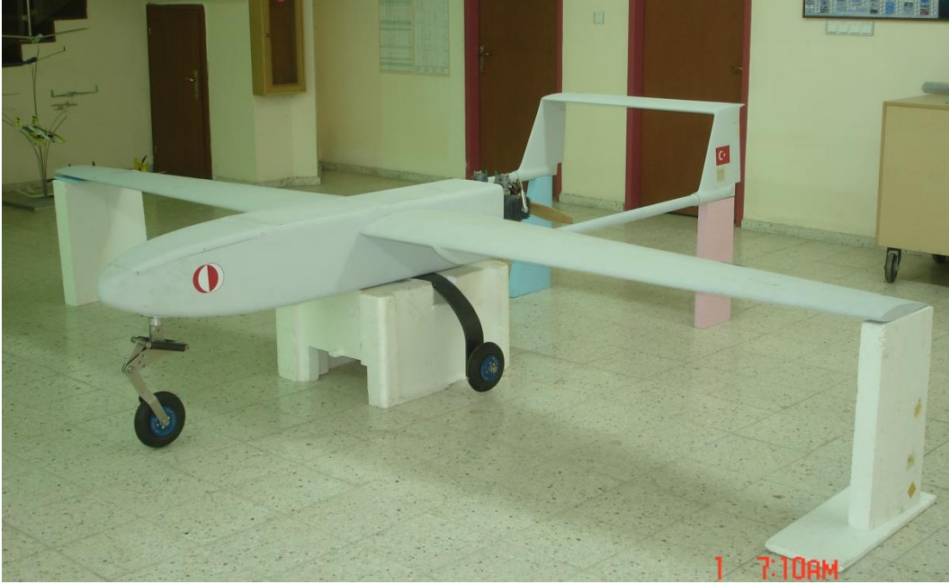
Şekil C1.1 Kanat, kuyruk düzlemi, ön ve arka iniş takımları ve motoru bir araya getirilmiş hava aracı-yan/ön görüntü
