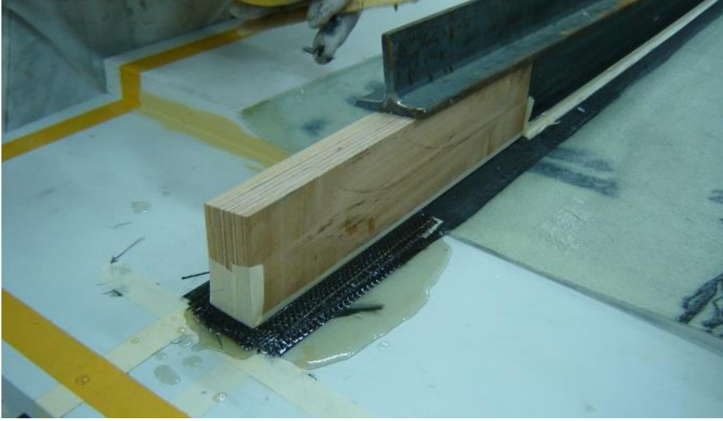
Şekil E-24 Gürgen bloğun altına karbon-epoksi kompozit katlar ile yapılan dolgu
