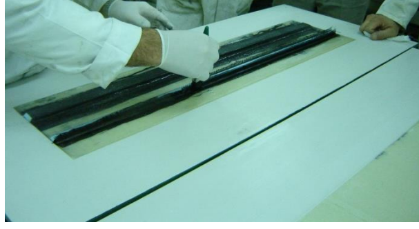
Şekil E-93 Yatay Kuyruk Arka Kirişinin Yatay Kuyruk Alt Kabuğu İle Bütünleşik Hale Getirilmesi
