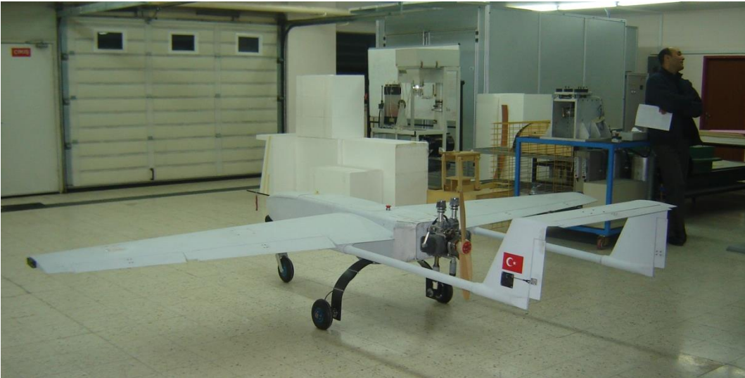
Şekil 6.3 Kanat, kuyruk düzlemi, ön ve arka iniş takımları ve motoru bir araya getirilmiş hava aracı-yan/arka görüntü
