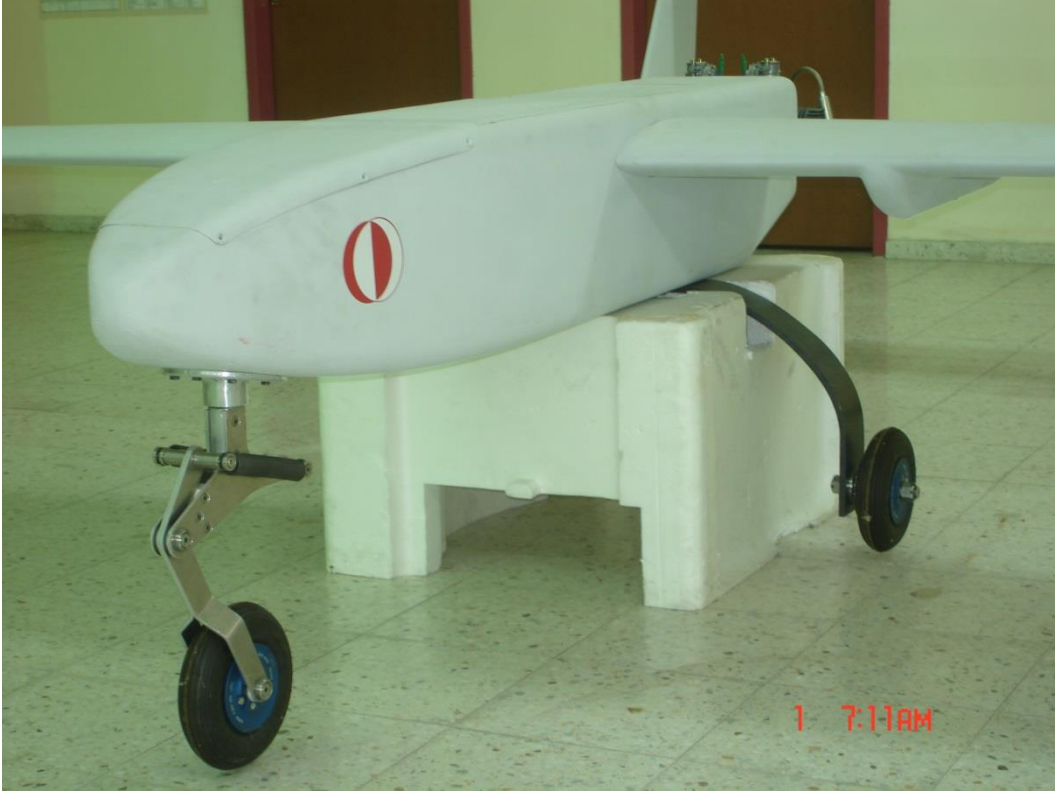
Şekil C1.4 Kanat, kuyruk düzlemi, ön ve arka iniş takımları ve motoru bir araya getirilmiş hava aracı-Yan/ön yakın görüntü
