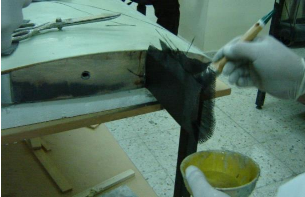
Şekil E-42 Kiriş köküne birleştirici karbon-epoksi kompozit katmanı uygulanması
