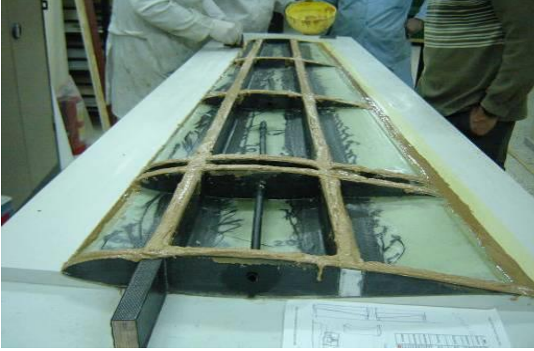
Şekil E-38 Yapıştırıcı karışımın yüzeylere uygulanması
