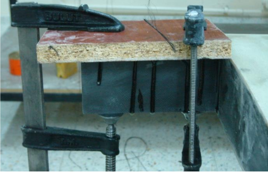
Şekil E-43 Uygulanan katın donması esnasında kullanılan işkence ve tahta bloklar
