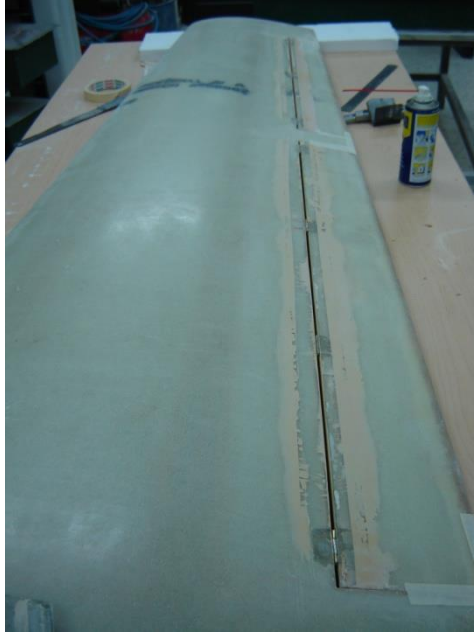
Şekil E-60 Kontrol yüzeyi montajı yapılmış kanat
