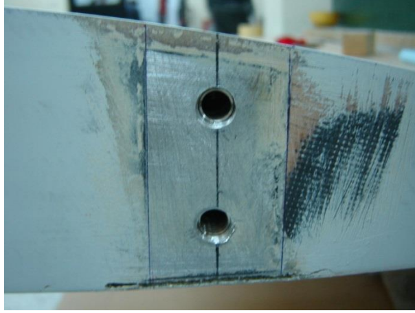
Şekil C1.11 Kanat gövde bağlantısı – arka kiriş vida bağlantıları
