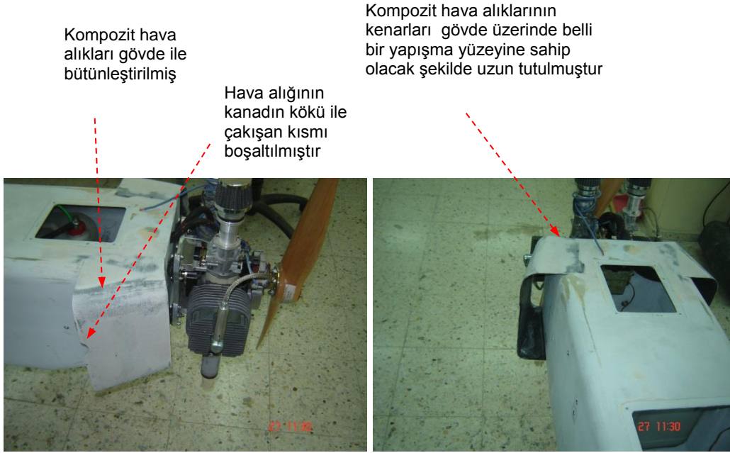
Şekil C1.24 Kompozit motor hava alığı
