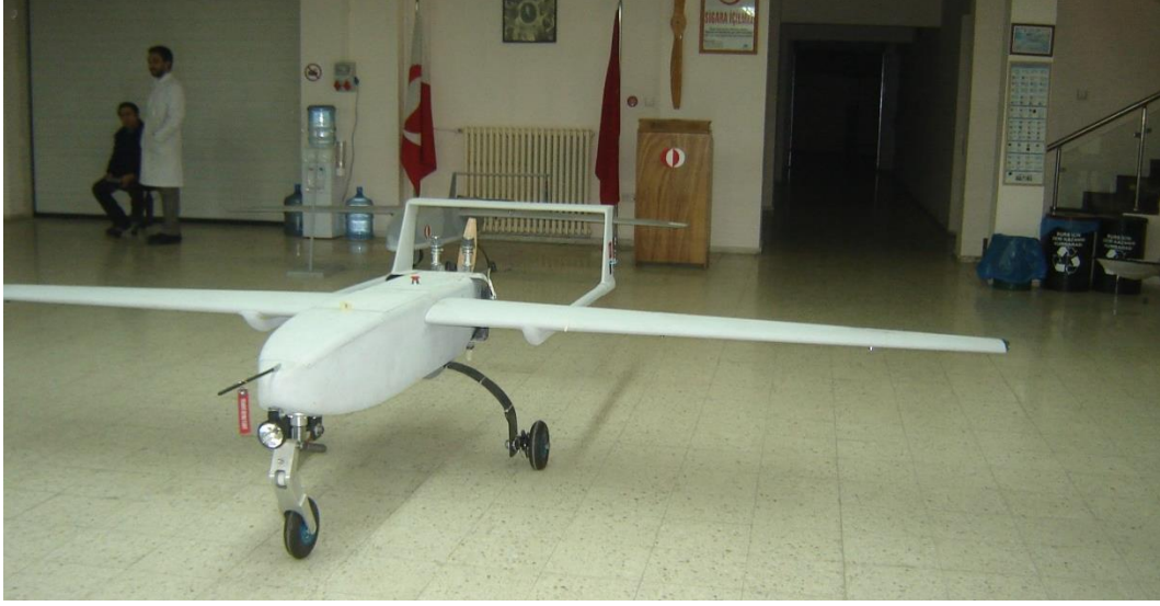
Şekil 6.2 Kanat, kuyruk düzlemi, ön ve arka iniş takımları ve motoru bir araya getirilmiş hava aracı-yan/ön görüntü
