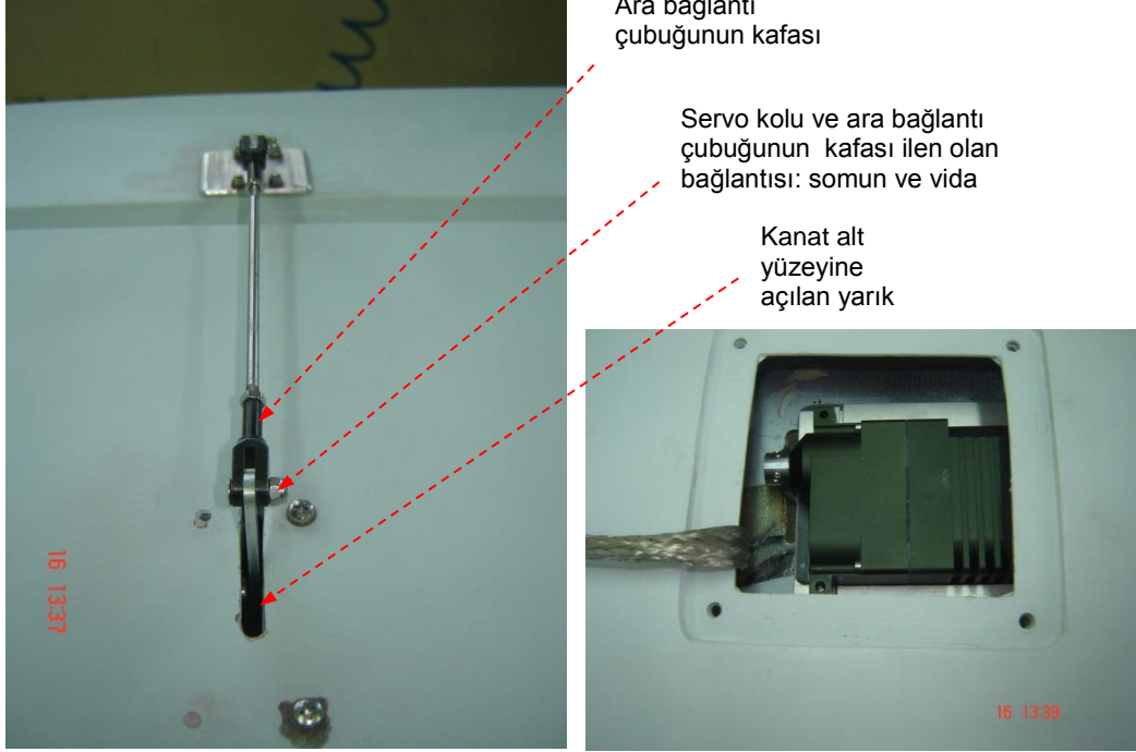
Şekil C1.44 Kanatçık kontrolü için kanada takılan PA-R-250-8 servo motoru, yekesi, servo kolu, ara bağlantı çubuğu ve kafasının yakın görüntüsü
