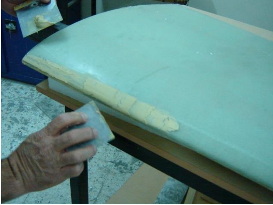
Şekil E-41 Hücüm kenarının pürüzlerini gidermek için çelik macunu uygulanması
