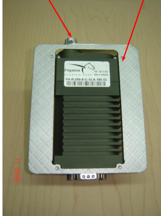
Şekil C1.33 PA-R-250-8 servo motorunun alt bağlama tablasının alttan görüntüsü ve RS 232 konnektörü
