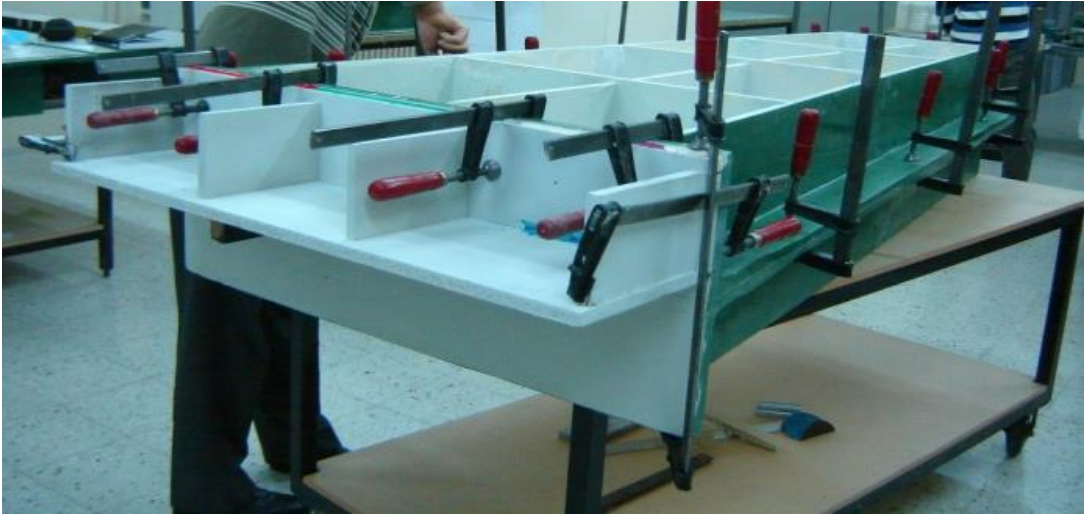
Şekil E-40 Kanat alt ve üst yüzey kalıplarının birbirlerine işkenceler yardımıyla sabitlenmesi
