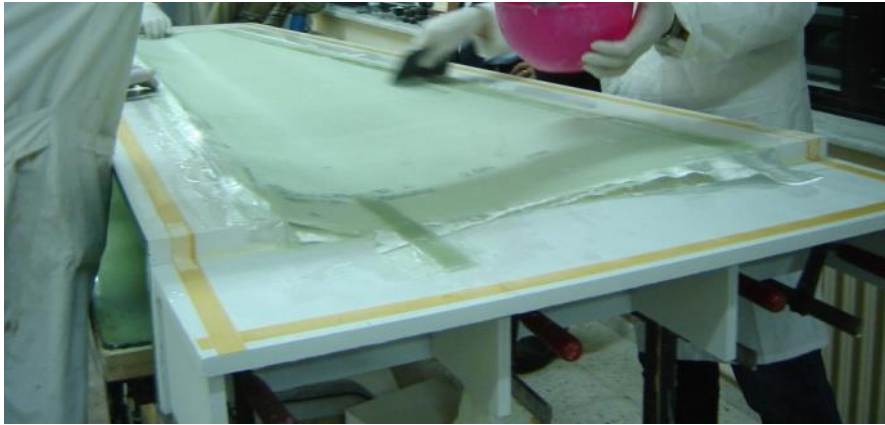
Şekil E-5 Son Kat Cam Elyafın Yerleştirilmesi.
