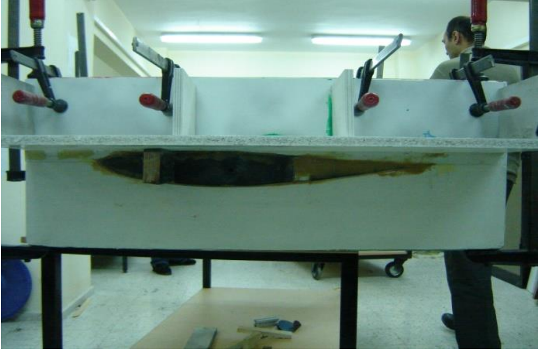
Şekil E-39 Kanat alt ve üst yüzeylerinin kalıplar yardımıyla birleştirilmesi
