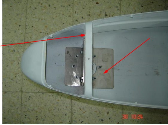
Şekil C1.39 Ön iniş takımı gövde bağlantısının gövde içi görüntüsü
