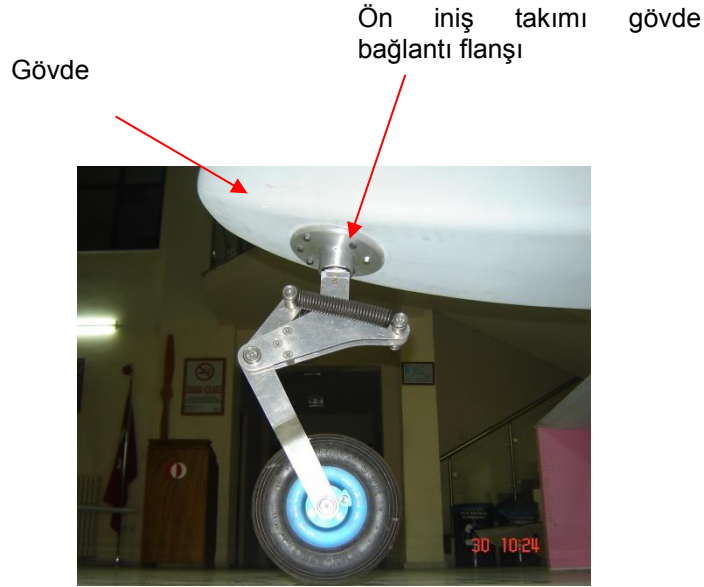
Şekil C1.38 Ön iniş takımı gövde bağlantısının gövde dışı görüntüsü
