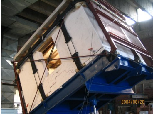
a) 34 derecede oluşan küçük çatlaklar b) Deney sonrası bina ve deney ekibi Şekil 102 – Güçlendirilmiş yığma bina deneyi
