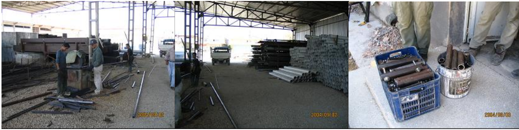
Şekil 157 – Adaptörlerin borular kesilerek hazırlanması.
