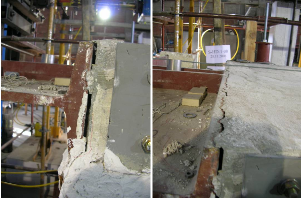
Şekil 148 – Düşey ve çapraz elemanlar ile güçlendirilen deney düzeneği, yükleme kirişi ayrılma problemi.
