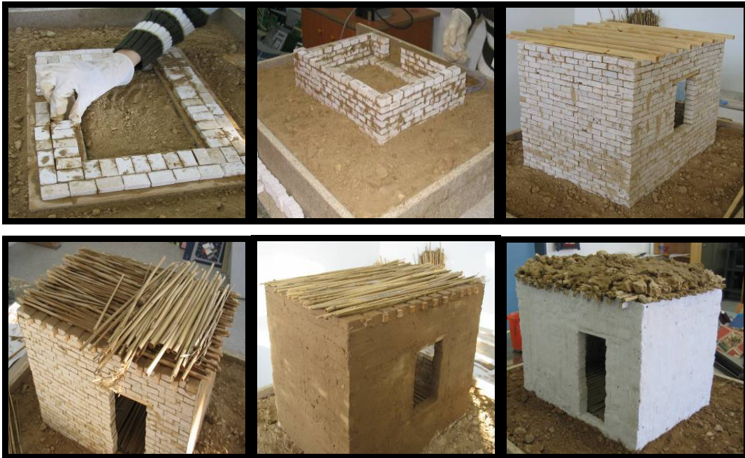
Şekil 98 – Deney numunelerinin planı ve hazırlanışı
