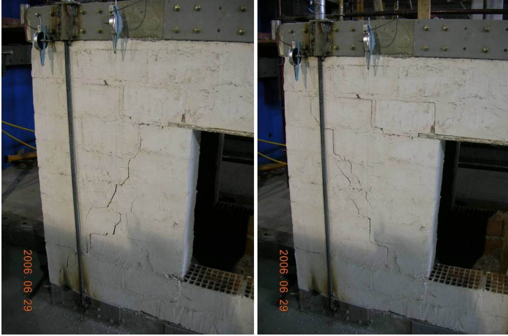
Şekil 141 – Düşey gergili test, diyagonal çatlakların oluşumu
