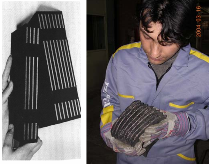
Şekil 4 – Tipik elastomerik yastık ve araba lastiği yastığı (ALYA).
