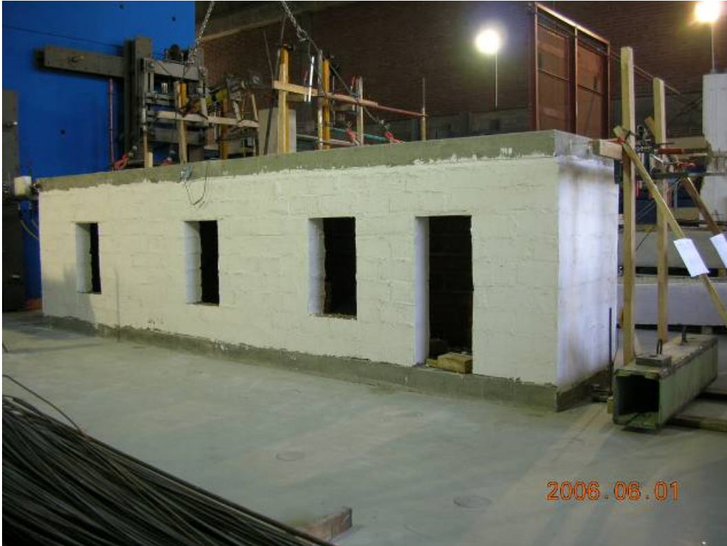
Şekil 128 – Güçlendirilmemiş bina genel görünüm
