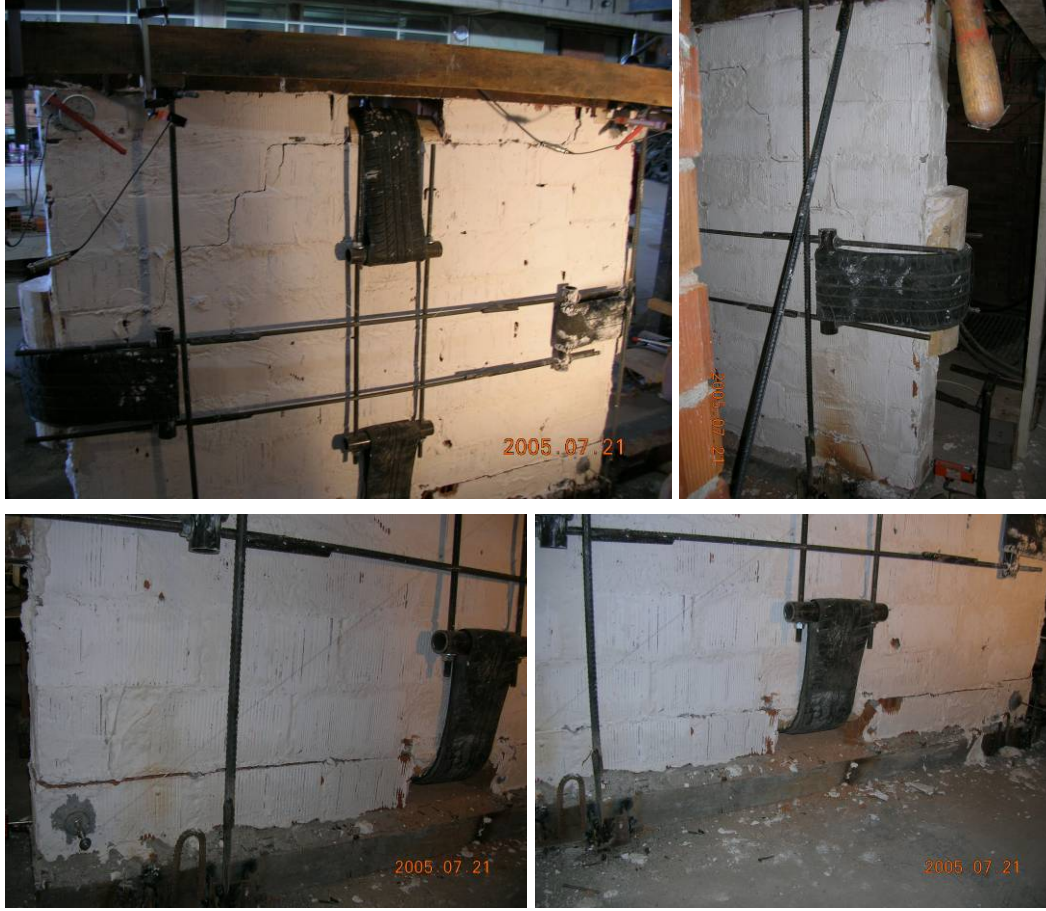
Şekil 92 – Düşey ve yatay yönde güçlendirilmiş duvar deneyi fotoğrafları
