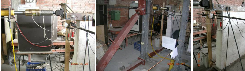
Şekil 73 – Kılıcına yönde test edilen güçlendirilmemiş duvar düzeneği
