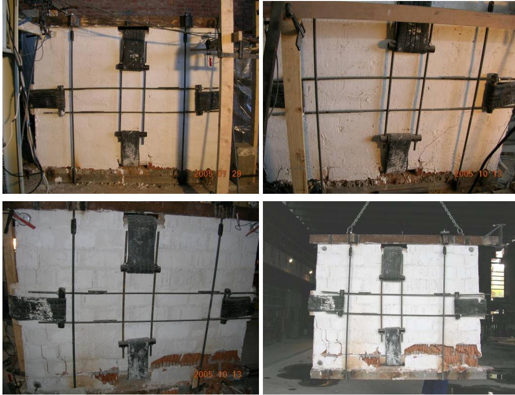
Şekil 95 – Somunlu düşey elemanlar ve düşey - yatay güçlendirilmiş duvar deneyi
