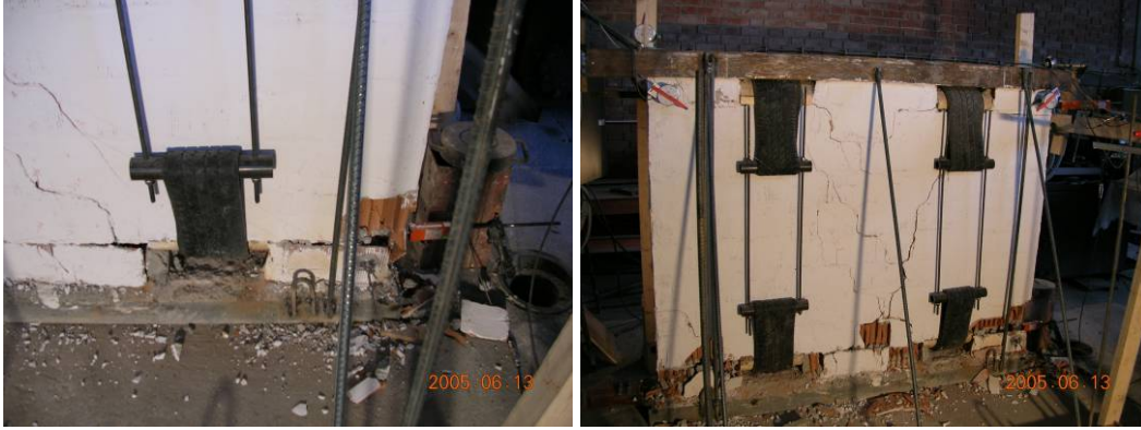
Şekil 87 – Düşey yönde güçlendirilmiş duvar deneyi
