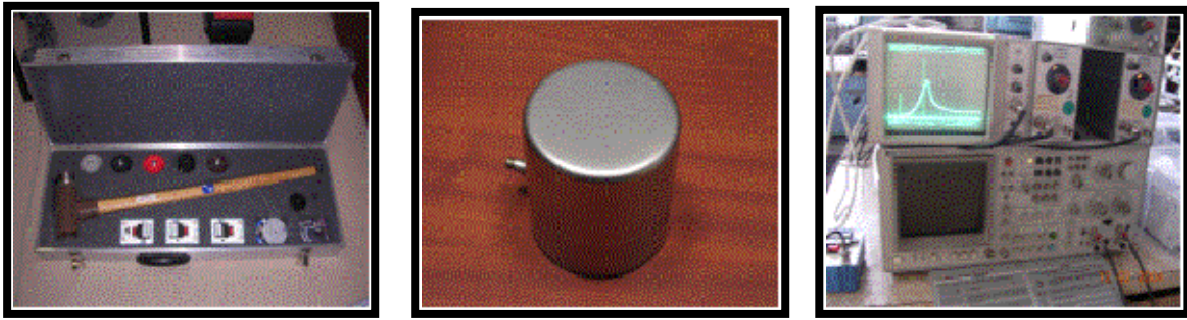
Şekil 17 – Sarsma çekici, İvmeölçer, Spektrum Analiz Makinesi
