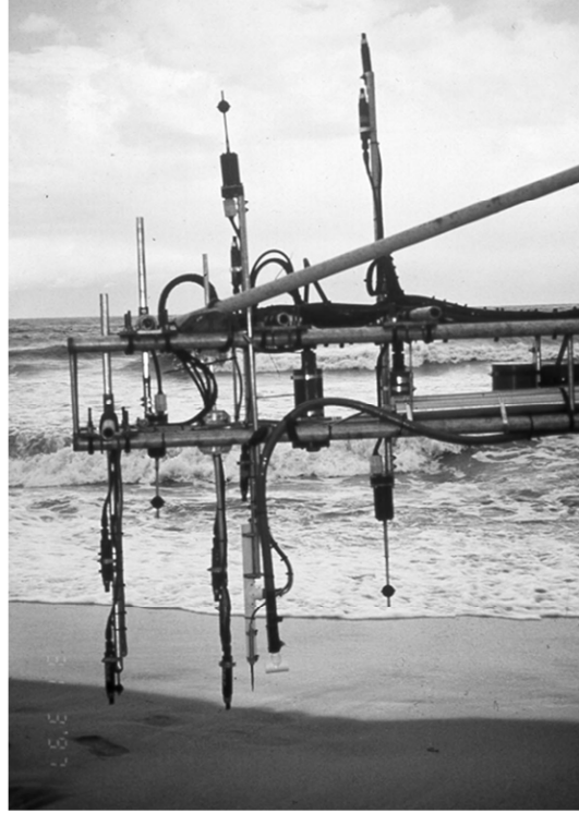
Şekil 3.68 Ölçüm sistemine bağlı su seviyesi, hız, konstrasyon ölçerler (Miller, 1999)
