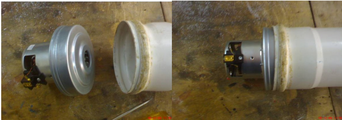
Şekil 3.1 Boru ve motor montajı.
