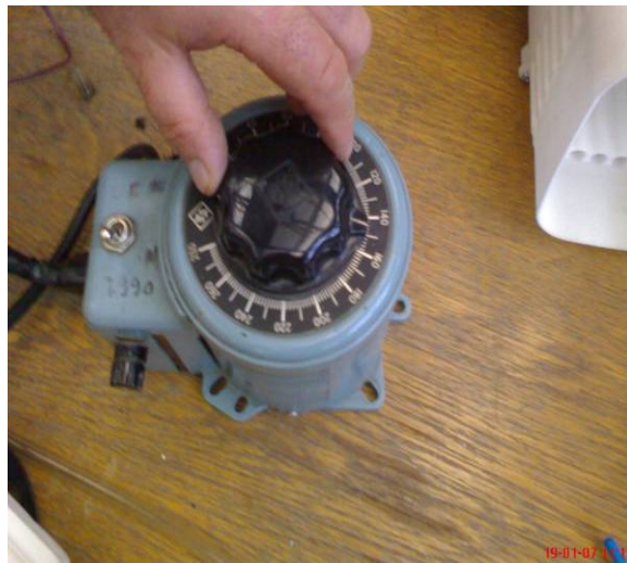
Şekil 3.5 Fan Hızını Ayarlamak İçin Kullanılan Varyak
