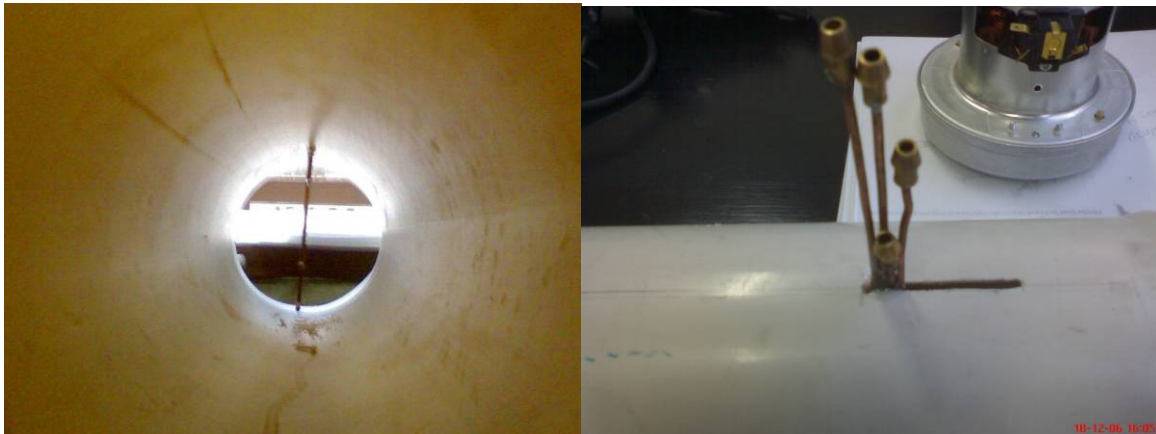
Şekil 3.3 Boru içinde pitot tüpler ve çıkışları.
