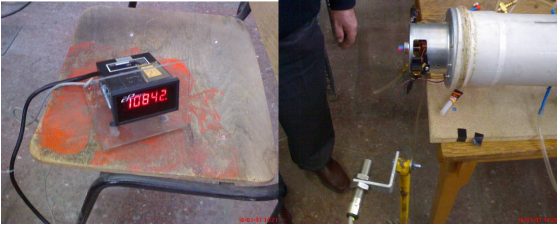
Şekil 3.6 Fan Dönüş Hızının Lazerli Takometre ile Ölçülmesi.
