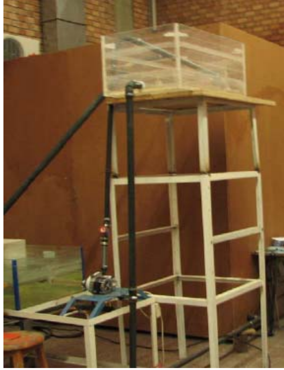
Şekil 2.4 İkinci Sistem için Emme Tankı ve Geri Besleme Pompası
