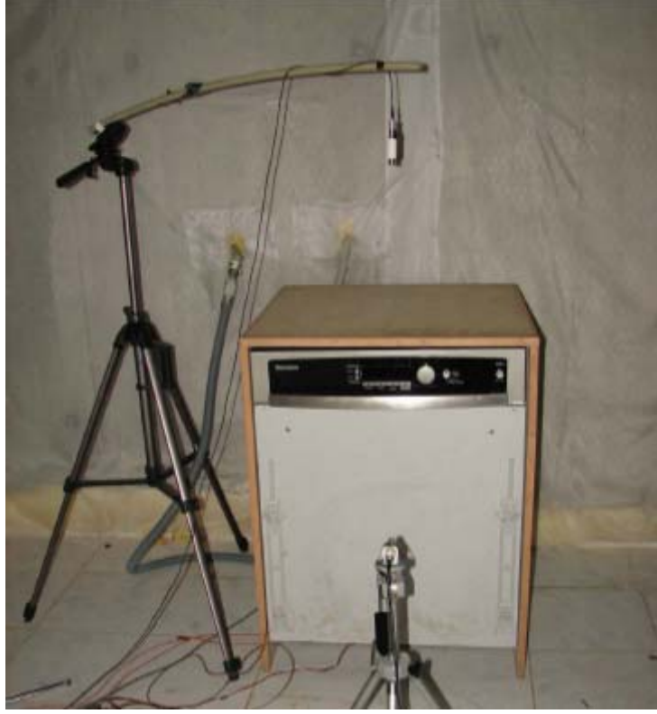
Şekil 2.22 Bulaşık Makinası ve İki Mikrofonun Oda İçinde Konumu
