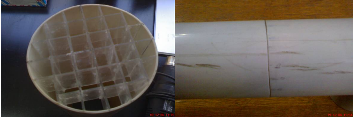
Şekil 3.2 Akış doğrultucu ve boru üzerindeki konumu
