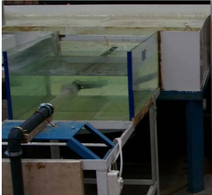
Şekil 2.1 Pompa Girişindeki Su Tankı
