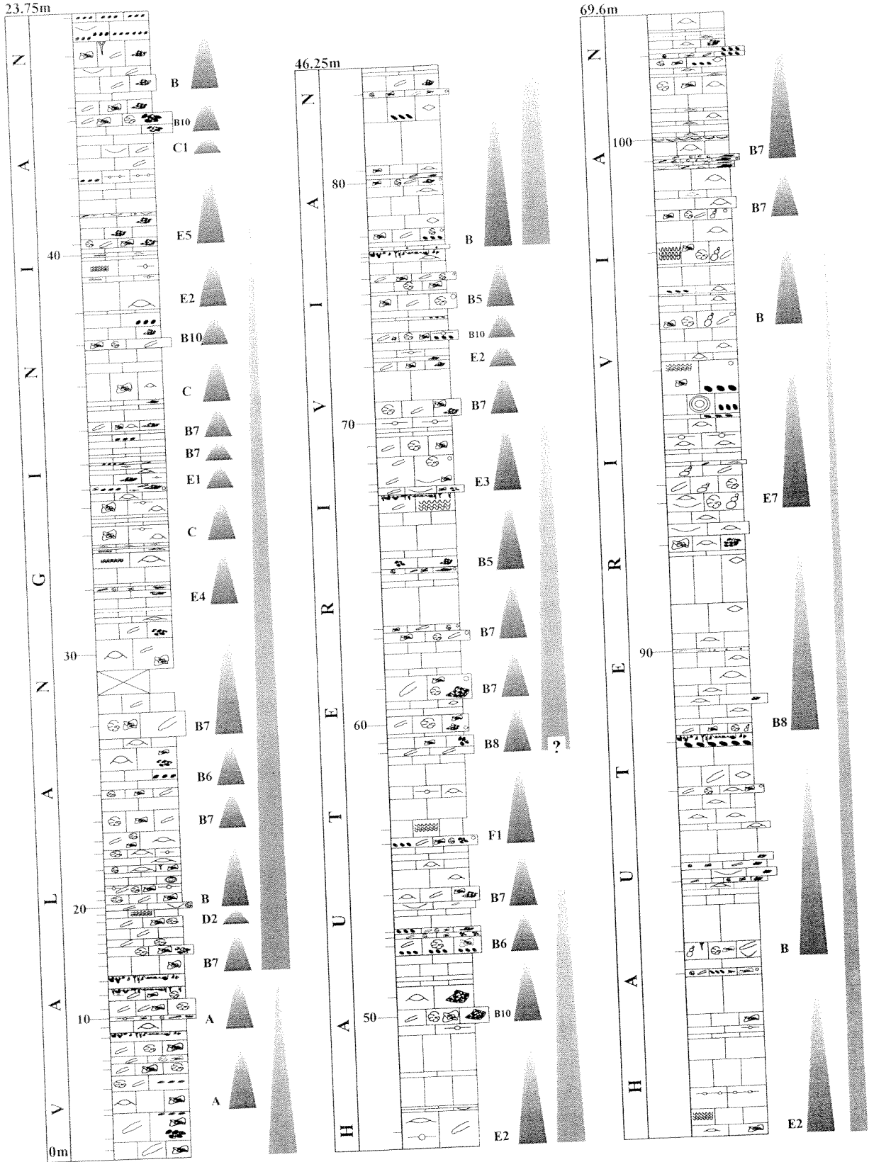
Şekil 25. Üzümlü yöresinde Valanjiniyen-Albiyen aralığında ölçülen kesitte metre ölçeğinde devirsel çökeller (parasekanslar). Küçük oklarla gösterilenler devirsel çökellerdir. Büyük harf ve rakamla verilen semboller devirsel çökel tiplerini göstermektedir (bakınız şekil 15). Uzun oklar ise 3. derece sekanslara karşılık gelmektedir.
