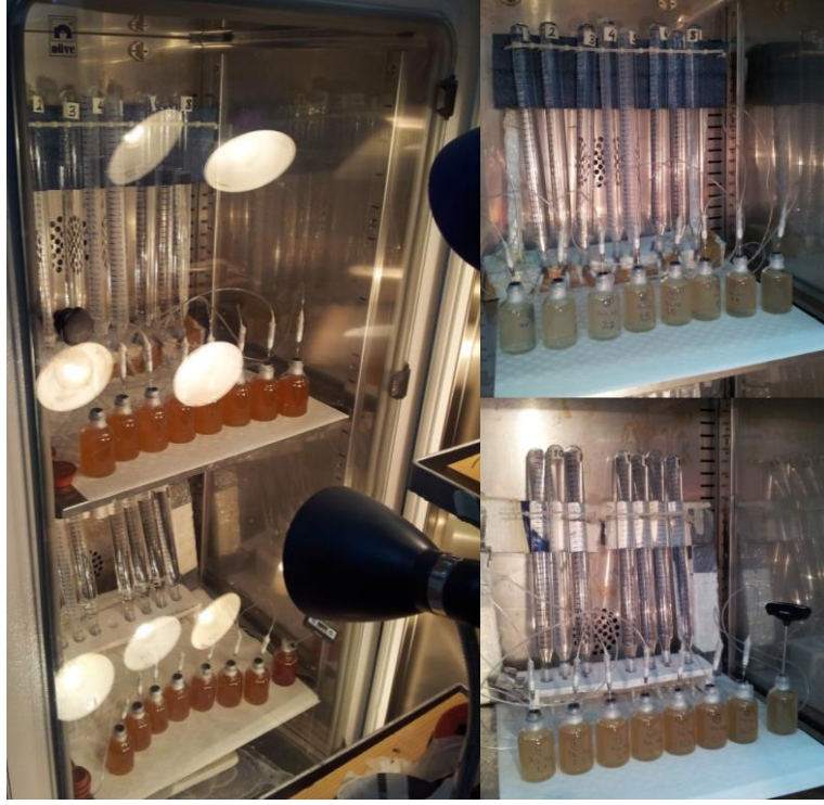
Şekil 3.2. Kesikli fotofermantasyon deneylerinde kullanılan deney düzeneği
