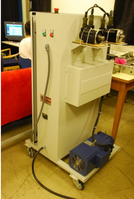
Şekil 3.8: Geliştirilen denetleyici prototiplerin ön sınamalarının yapıldığı düzenek.
