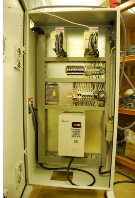
Şekil 3.8: Geliştirilen denetleyici prototiplerin ön sınamalarının yapıldığı düzenek.
