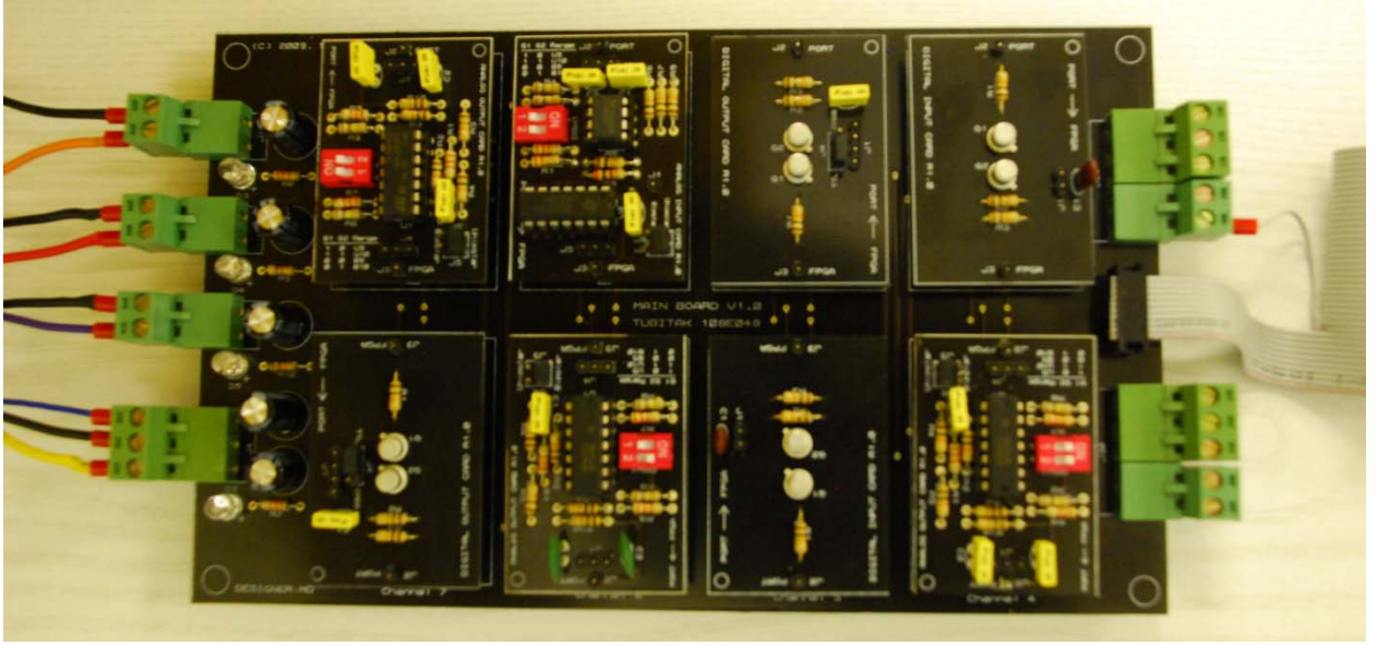
Şekil 2.3: Ana kart üzerine yerleştirilmiş yardımcı kartlar.
