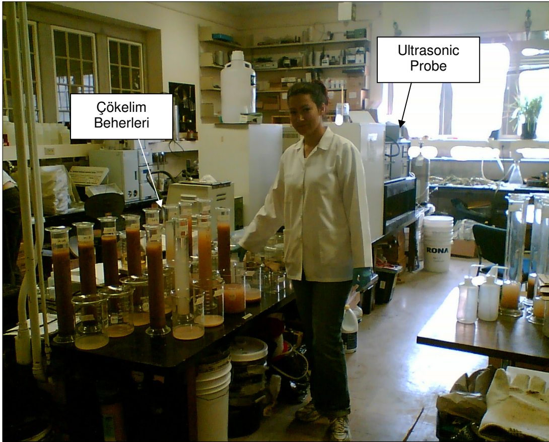
Şekil 2.17. University of Western Ontario' da Jeoloji Bölümü örnek hazırlama laboratuvarında kil fraksiyonunu kil dışı malzemeden ayırma işlemi.
