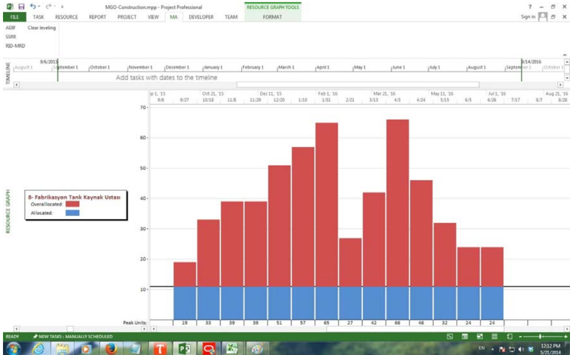
Şekil 35. Fabrikasyon tank kaynak ustası için erken başlangıç kaynak profili
