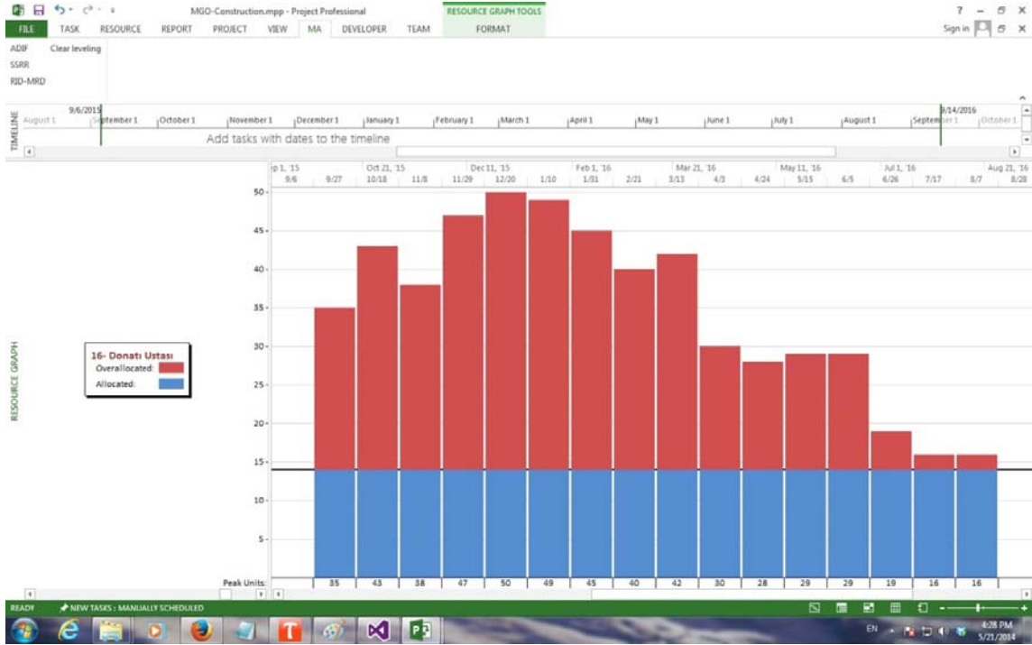
Şekil 38. Donatı ustası için TBMA eklentisi ile dengelenmiş kaynak profili
