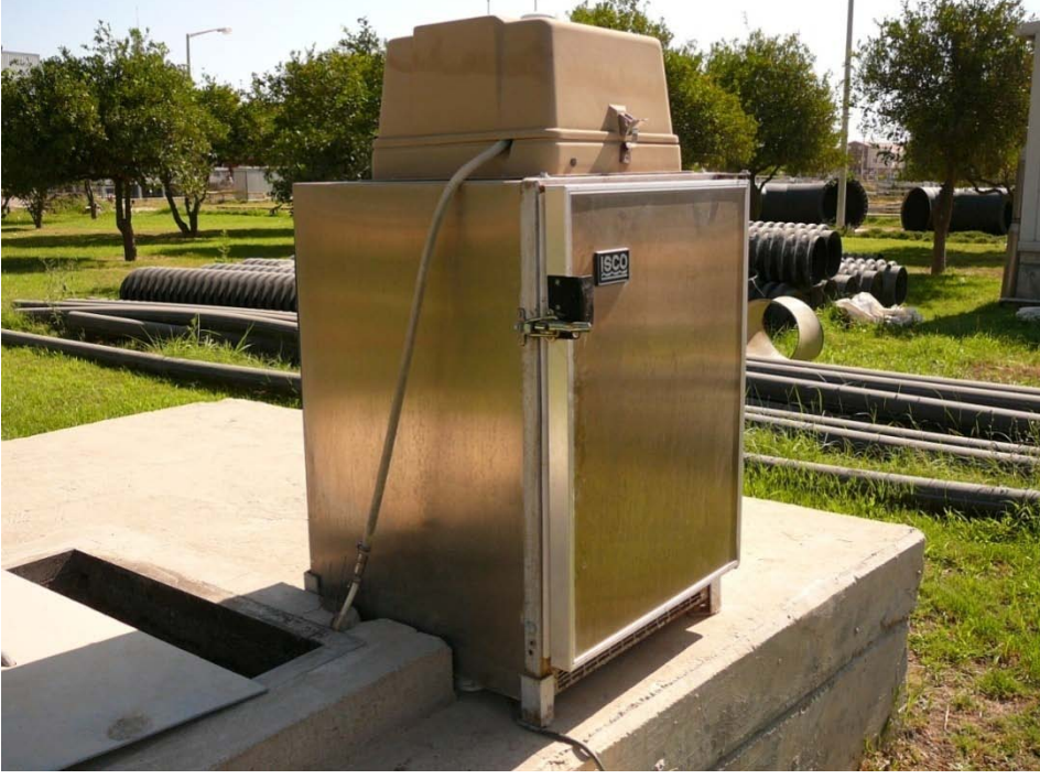
Şekil 2.15. Hurma tesisi giriş kompozit örnekleme cihazı
