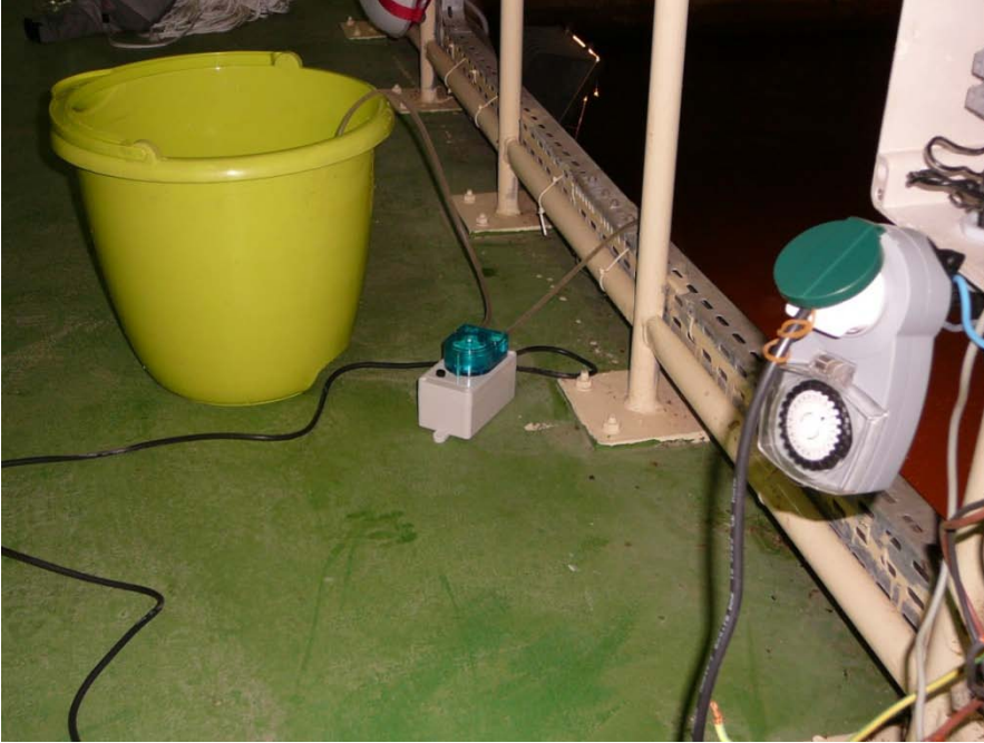
Şekil 2.20. Lara tesisi anoksik havuz kompozit örnekleme düzeneği
