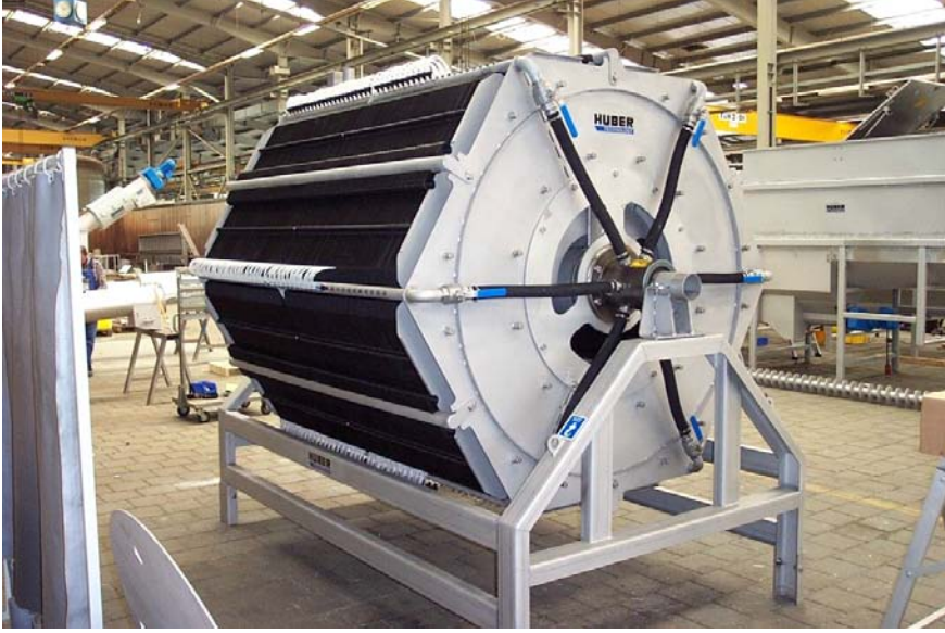
Şekil 2.30. VRM Membran ünitesinden bir görünüş
