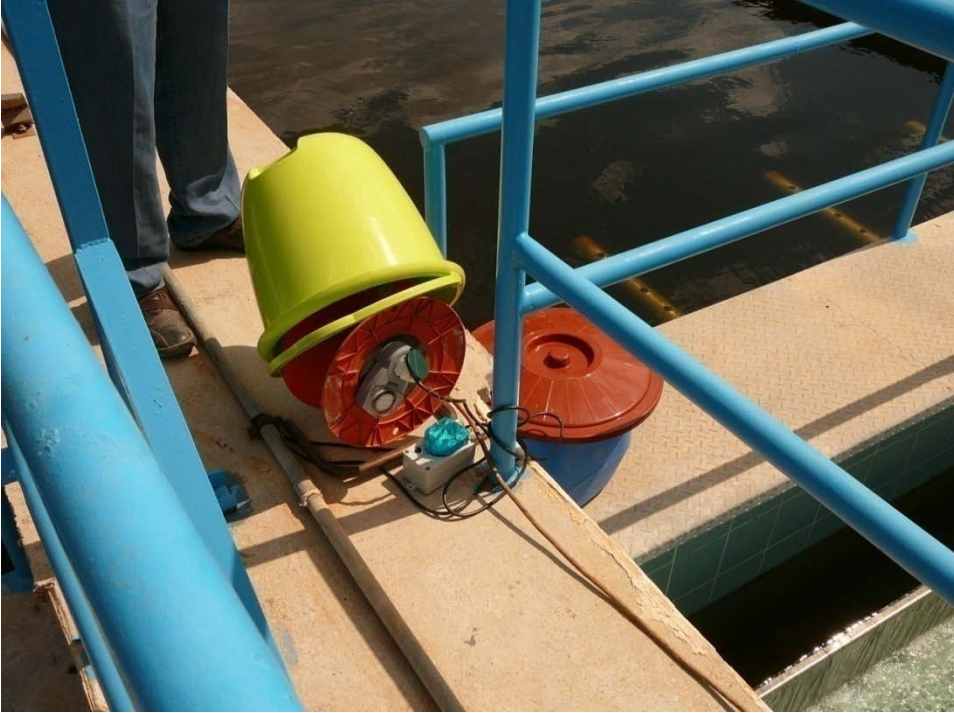
Şekil 2.23. Kemer 1 tesisi son çöktürme tankı çıkışına kurulan kompozit örnekleme düzeneği
