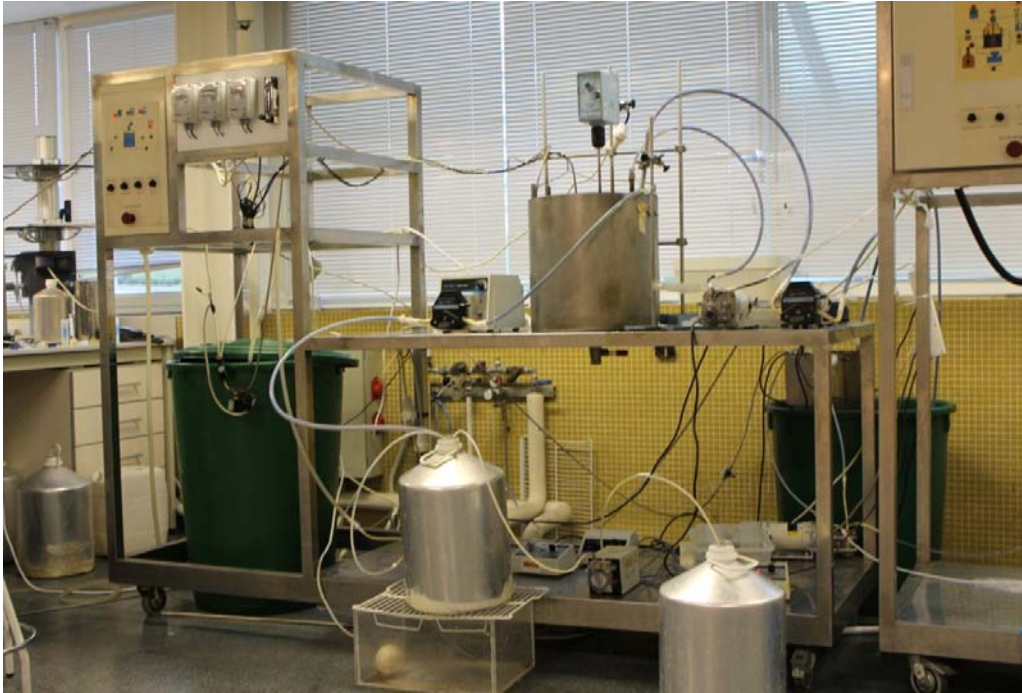
Şekil 2.39. Lab AKR + Membran ünitesi
