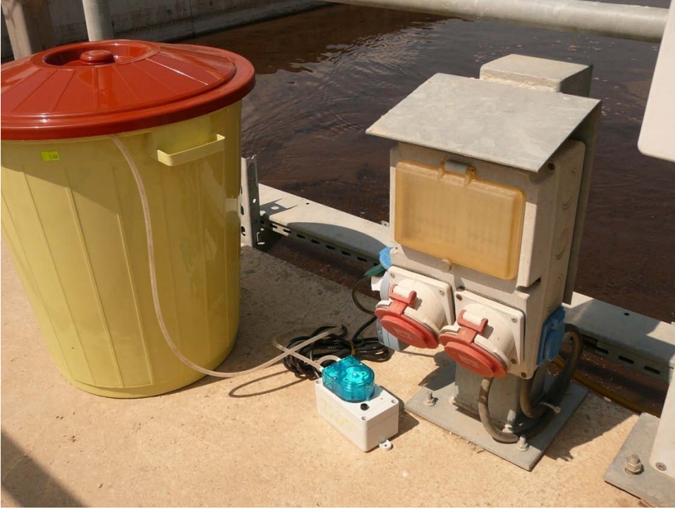
Şekil 2. 16. Hurma tesisi anoksik tankından kompozit örnekleme yapabilmek için tarafımızdan kurulan örnekleme cihazı
