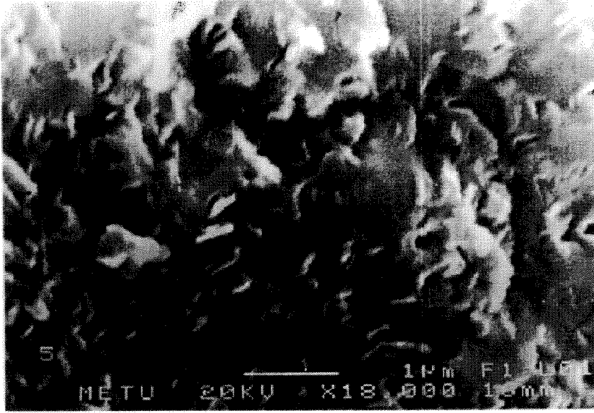
Şekil 28. Ağırlıkça %0.5 ZrO 2 içeren bir cam-seramiğin TEM mikrofotografı. Numune tek kademeli ısıl işleme göre dane büyümesi sıcaklığında, 950 °C'de 8 saat tutulmuştur.(X 18,000).
