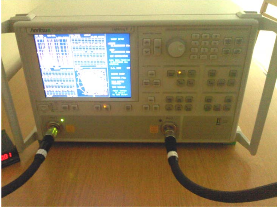
Şekil E.10. Proje kapsamında EM ölçüm yapmak üzere kullanılmış vektörel ağ analizörü.
