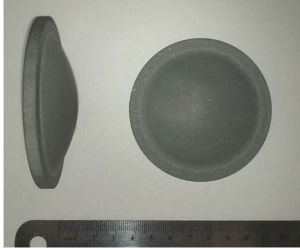
Şekil E.5. Hesaplamaları yapılarak modellenen ve CNC tarafından işlenen polimerik lenslerin yukarıdan ve karşıdan görünümü.
