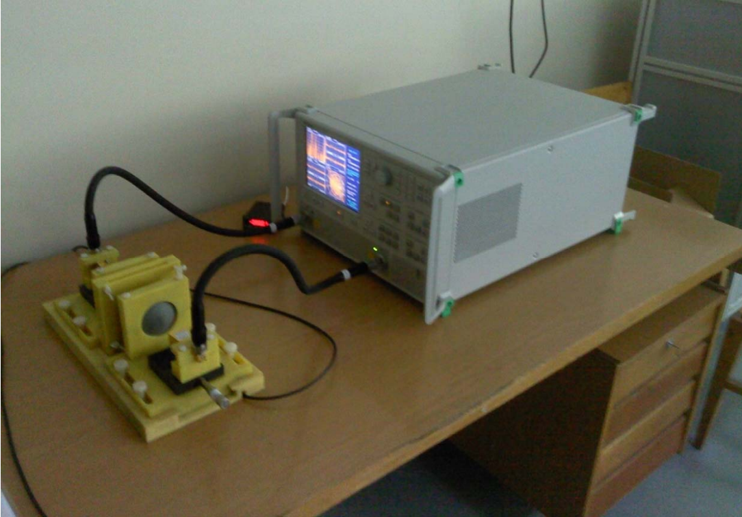
Şekil E16. Serbest uzay ölçüm düzeneği ve vektörel ağ analizörü.
