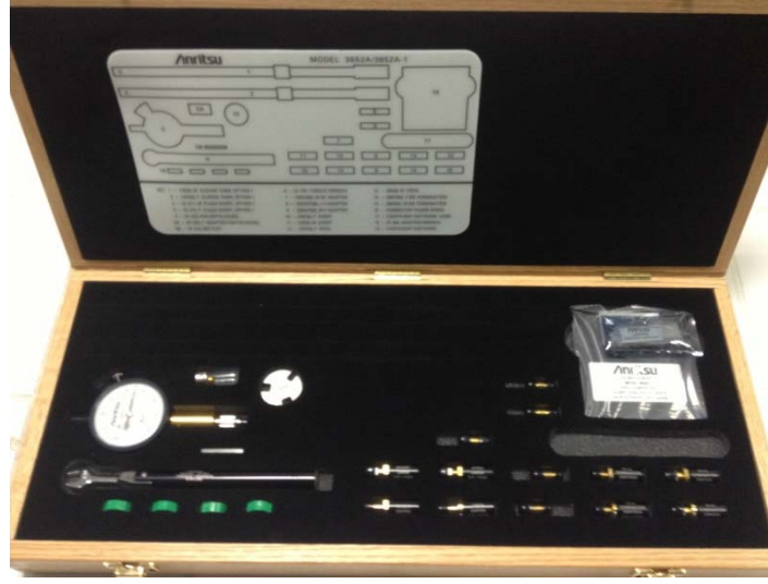
Şekil E.11. Farklı yükler ve açık devre parçalarından oluşan kalibrasyon kiti.
