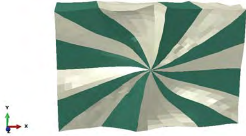
Şekil 62. 16 dilimli küresel mikro-yapının çekme yüklemesi analizi sonunda elde edilen şekil değiştirmiş sonlu elemanlar ağı. Deformasyon ölçekleme katsayısı kullanılmamıştır. Koyu renkli dilimler amorf, açık renkli dilimler kristal fazı temsil etmektedir.
