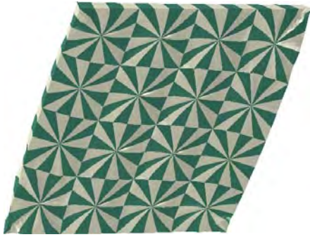
Şekil 97. Eş hacimde 4x4 adet bulunan küresel mikro-yapının kesme yüklemesi analizi şekil değiştirmiş sonlu elemanlar modeli. Deformasyon ölçekleme katsayısı kullanılmamıştır. Koyu renkli dilimler amorf, açık renkli dilimler kristal fazı temsil etmektedir.
