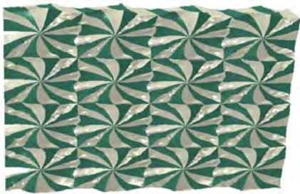
Şekil 99. Eş hacimde 4x4 adet bulunan küresel mikro-yapının çekme yüklemesi analizi şekil değiştirmiş sonlu elemanlar modeli. Deformasyon ölçekleme katsayısı kullanılmamıştır. Koyu renkli dilimler amorf, açık renkli dilimler kristal fazı temsil etmektedir.
