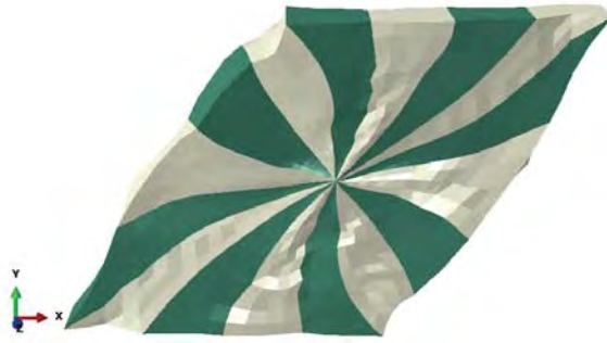
Şekil 60. 16 dilimli küresel mikro-yapının kesme yüklemesi analizi sonunda elde edilen şekil değiştirmiş sonlu elemanlar ağı. Deformasyon ölçekleme katsayısı kullanılmamıştır. Koyu renkli dilimler amorf, açık renkli dilimler kristal fazı temsil etmektedir.
