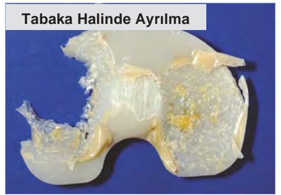
Şekil 4. Tibyal bileşende görülen yüzey hasarları (Kurtz vd., 2004)
