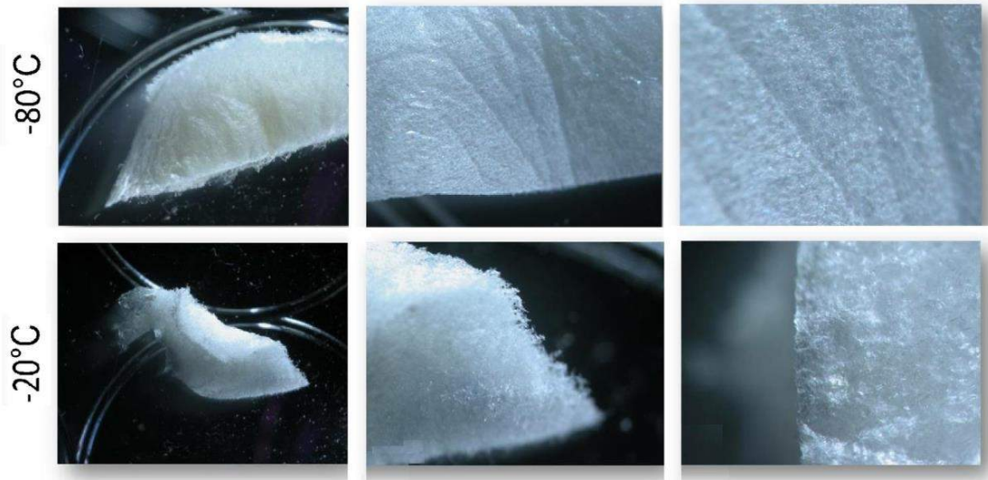
Şekil 4.1. Stereomikroskop ile çekilmiş büyük ve küçük gözenekli çapraz bağlı olmayan kollajen iskele görüntüleri (-20°C: büyük gözenekli: 98 µm), -80°C: küçük gözenekli: 65 µm))
