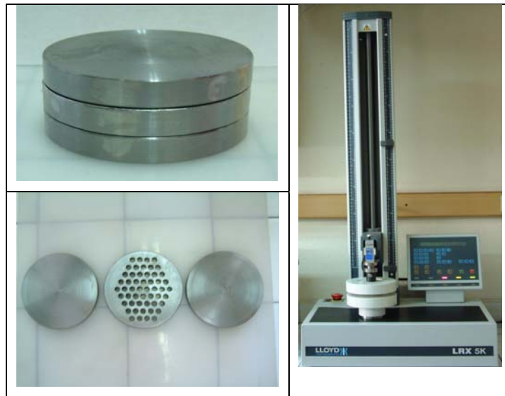
Şekil 2.2 Basma kalıbı ve deney düzeneği
