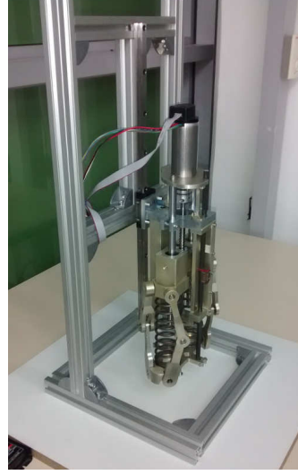
Şekil 7: Bacak platformu ve kızak düzeneği. Solda tasarım çizimleri, sağda ise prototipin üretilmiş son hali gösterilmektedir.
