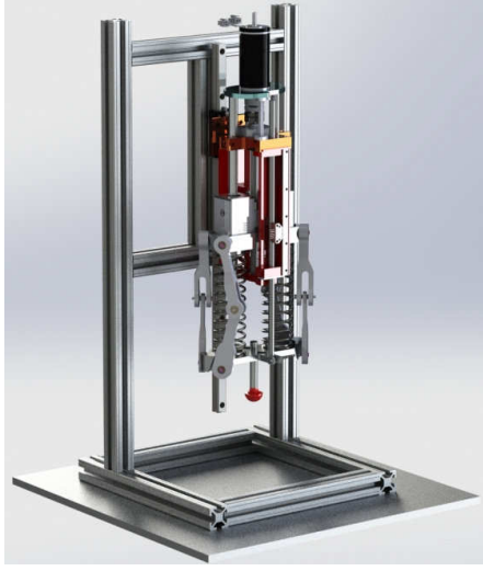
Şekil 7: Bacak platformu ve kızak düzeneği. Solda tasarım çizimleri, sağda ise prototipin üretilmiş son hali gösterilmektedir.
