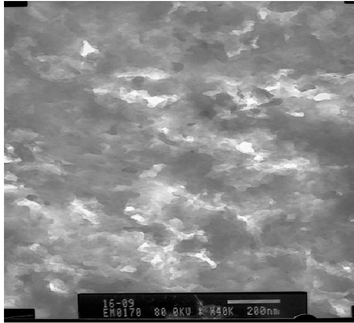
Şekil 46. Poli(metilsilseskuoksan) polimerinin TEM mikrografığı
