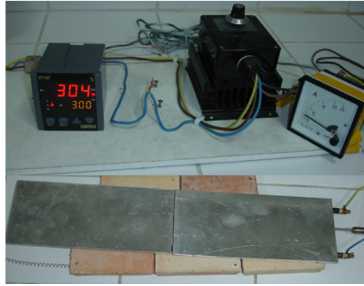
Şekil 3.31 Fırın düzeneği ve kontrol ünitesi
