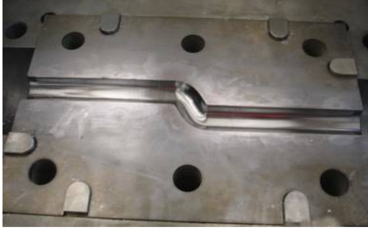
Şekil 3.11 18mm çaplı Çift 120° lik ECAP kalıbı.
