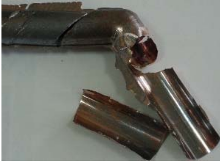
Şekil 3.13 Aşırı basınç yükselmesi sonucu ters ekstrüzyon ve numune sıkışması
