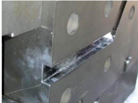
Şekil 3.10 Üretim sırasında çatlayan 14mmx14mm kare kesitli kalıp
