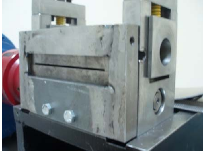
Şekil 3.25 Alt-üst kalıbı sabitleyen çerçeve tasarımı
