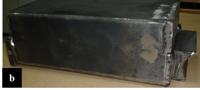
Şekil 3.30 (a) Merdane öncesi polyamid numune yolu, (b) Tasarlanan fırınlı numune yolu
