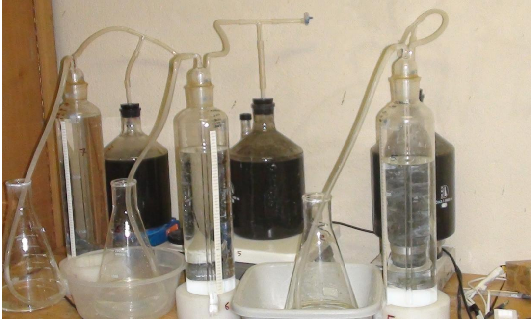
Şekil 2. Reaktörler ve gaz toplama ünitesini gösteren fotoğrafı
