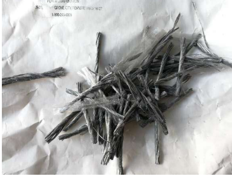
Şekil 3.109 Kullanılan sentetik lifler (altıncı deney).
