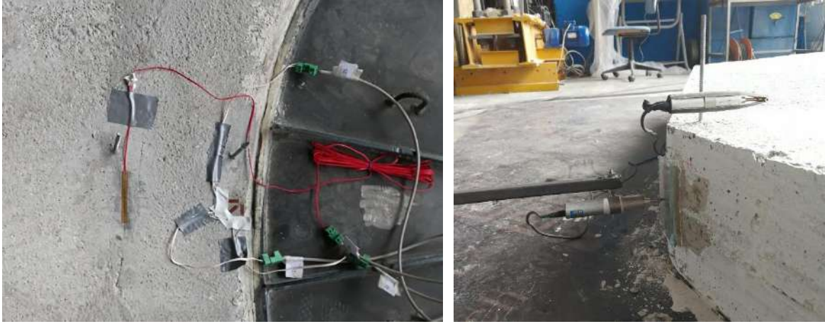
Şekil 3.14 Birinci deneyde kullanılan ölçüm sisteminin yerleştirilmiş hali.
