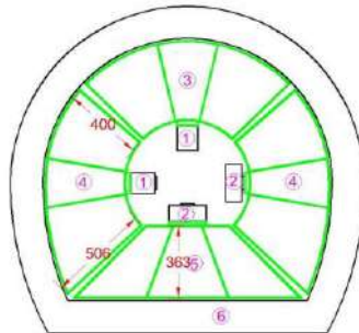
Şekil 3.10 Yükleme plakaları. 1. Pistonlar, 2. Yük hücreleri, 3. Yük aktarma plakaları, 4. Yük aktarma plakaları, 5. Yük aktarma plakaları, 6. Kaplama Betonu
