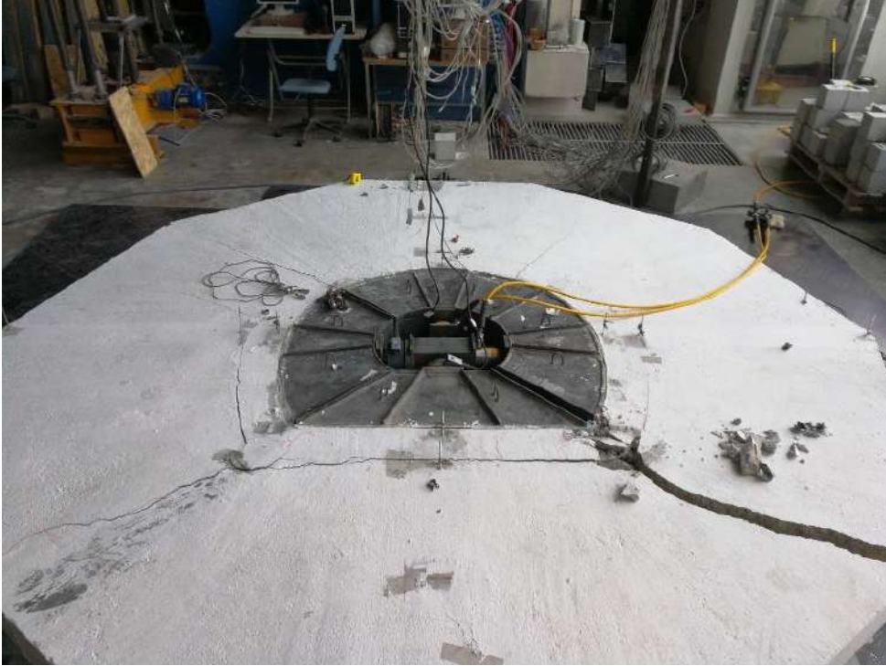
Şekil 3.21 Birinci deneyin sonunda gözlemlenen çatlak dağılımı.
