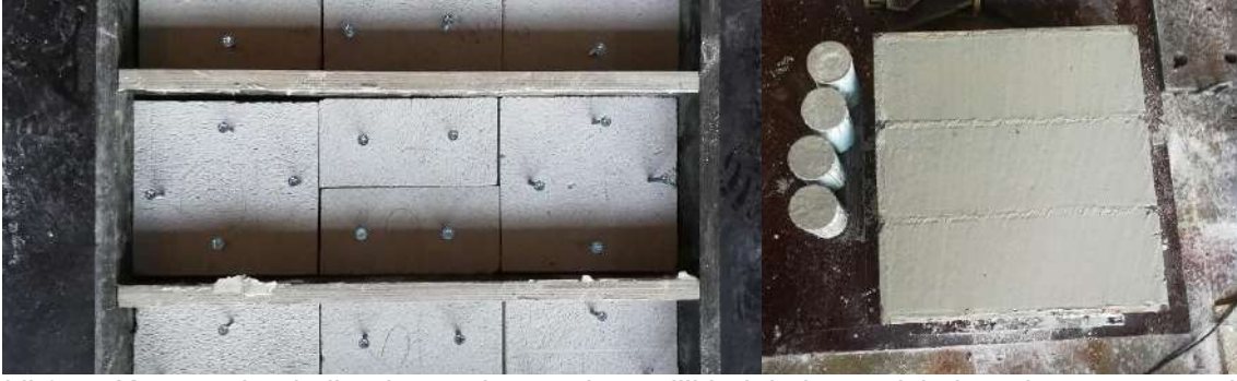
Şekil 3.56 Kaya yerine kullanılan malzemenin özelliklerini ölçümü için hazırlanan numuneler.
