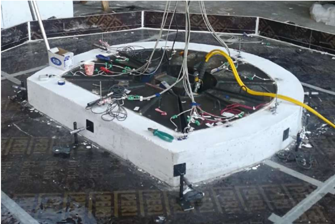
Şekil 3.26 İkinci deneyden hemen önce ölçüm ve yükleme sistemlerinin hazırlanmış hali.
