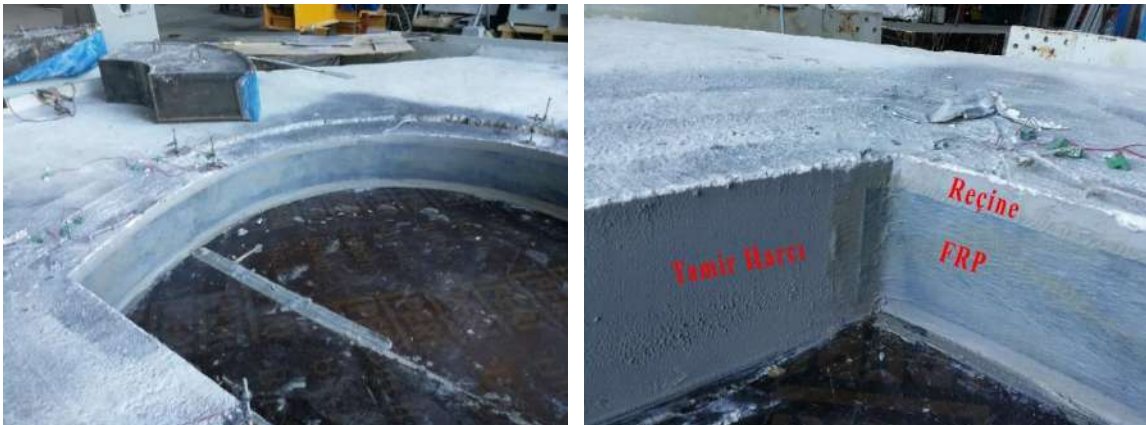
Şekil 3.98 Tamiratın tamamlanmış hali (beşinci deney).
