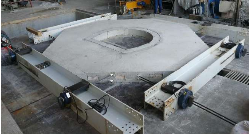
Şekil 3.55 Öngerme düzeneğinin yerleştirilmiş hali.
