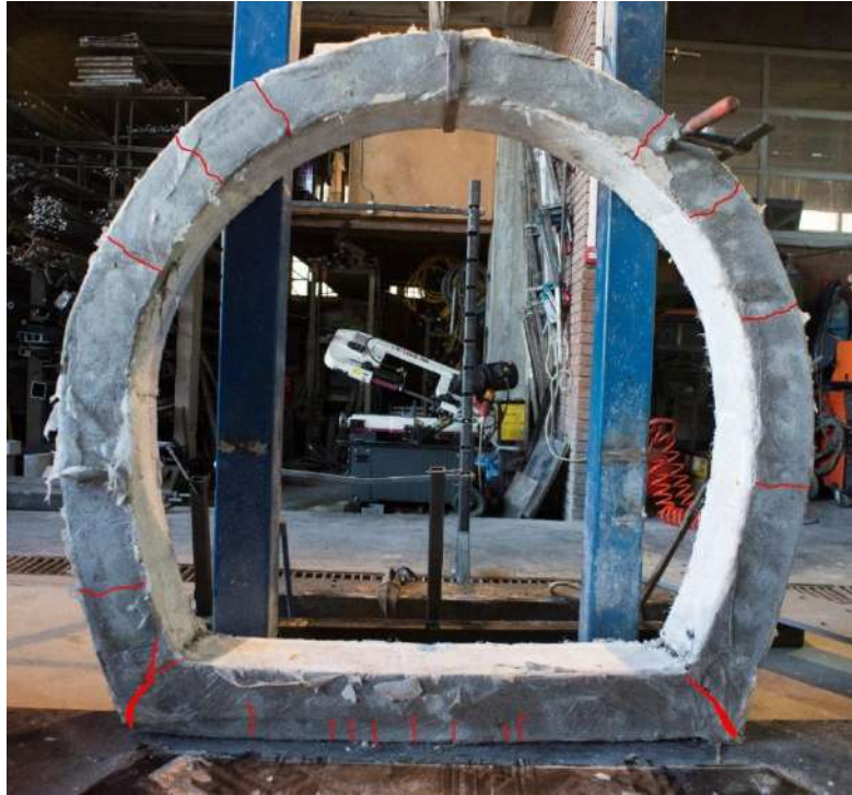
Şekil 3.115 Deney sonunda gözlemlenen çatlak dağılımı (altıncı deney).
