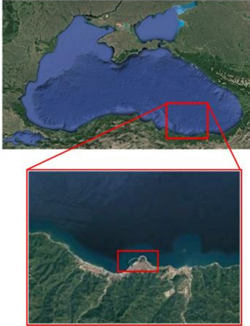
Şekil 6.1. Çalışma alanı, üst resimdeki kırmızı kutu ADCIRC+SWAN model sınırlarını kapsarken alt resimdeki kırmızı kutu NAMI DANCE model sınırlarını kapsamaktadır
