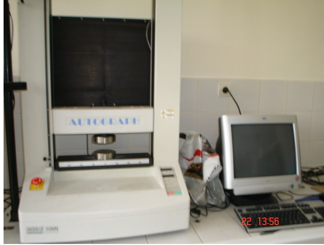
Şekil 13. Soğuk basma deneylerinde kullanılan test cihazı.
