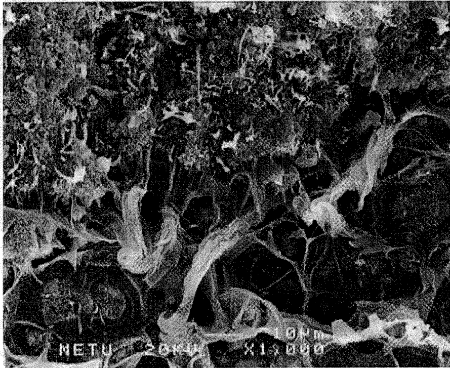
Şekil 4.26. %20 PPy içeren PP/PPy kompozitinin kopma yüzeyi
