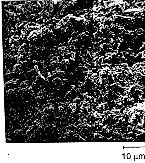
Şekil 3.1. 775°C'de kalsinasyon işlemine tabi tutulan Y-esaslı üstüniletken özellikler göstermeyen nümunenin SEM görüntüsü (x900).
