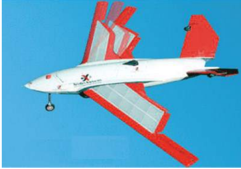
Şekil 6. NextGen firmasının “değişken açı, değişken veter” konsepti.
