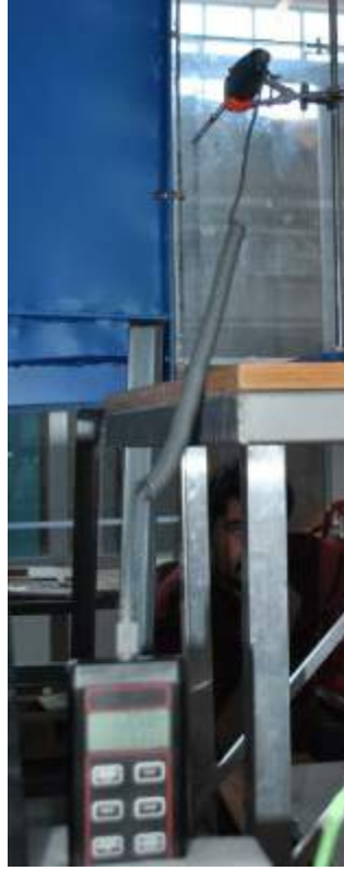
Şekil 50. Termo-anemometre hız ölçer ve rüzgar tüneli yerleşimi.
