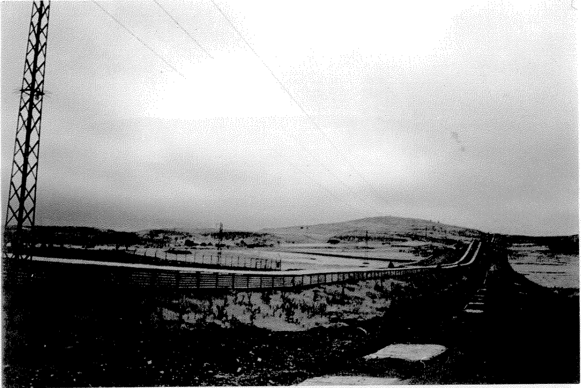
Şekil 4.2. Katı atıkları santraldan döküm alanlarına taşıyan konveyör bantların fotoğrafı
