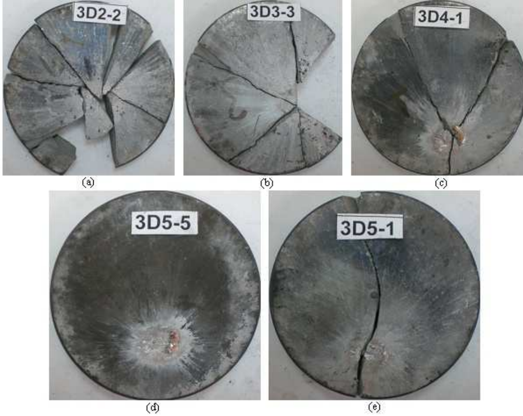
Şekil 5.3.18. 3D numunelerinin düşük alan yoğunluğundan (a) en yüksek alan yoğunluğuna (d ve e) doğru sıralanmış balistik deneyler sonucundaki ön yüz görüntüleri. 5.alan yoğunluğu hariç tüm numuneler delinmemiş ancak kırılarak başarısız olmuştur (a, b ve c). 5.Alan yoğunluğunda atışı yapılan 5 numuneden 3'ü başarılı olmuştur. (d ve e)
