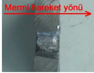
Şekil 5.4.4. Gevrek delinen 2B numunesinde mermi giriş bölgesinde sıyrılmanın etkisinin olmadığı ve çıkış yönünde genişlemenin gösterilmesi.
