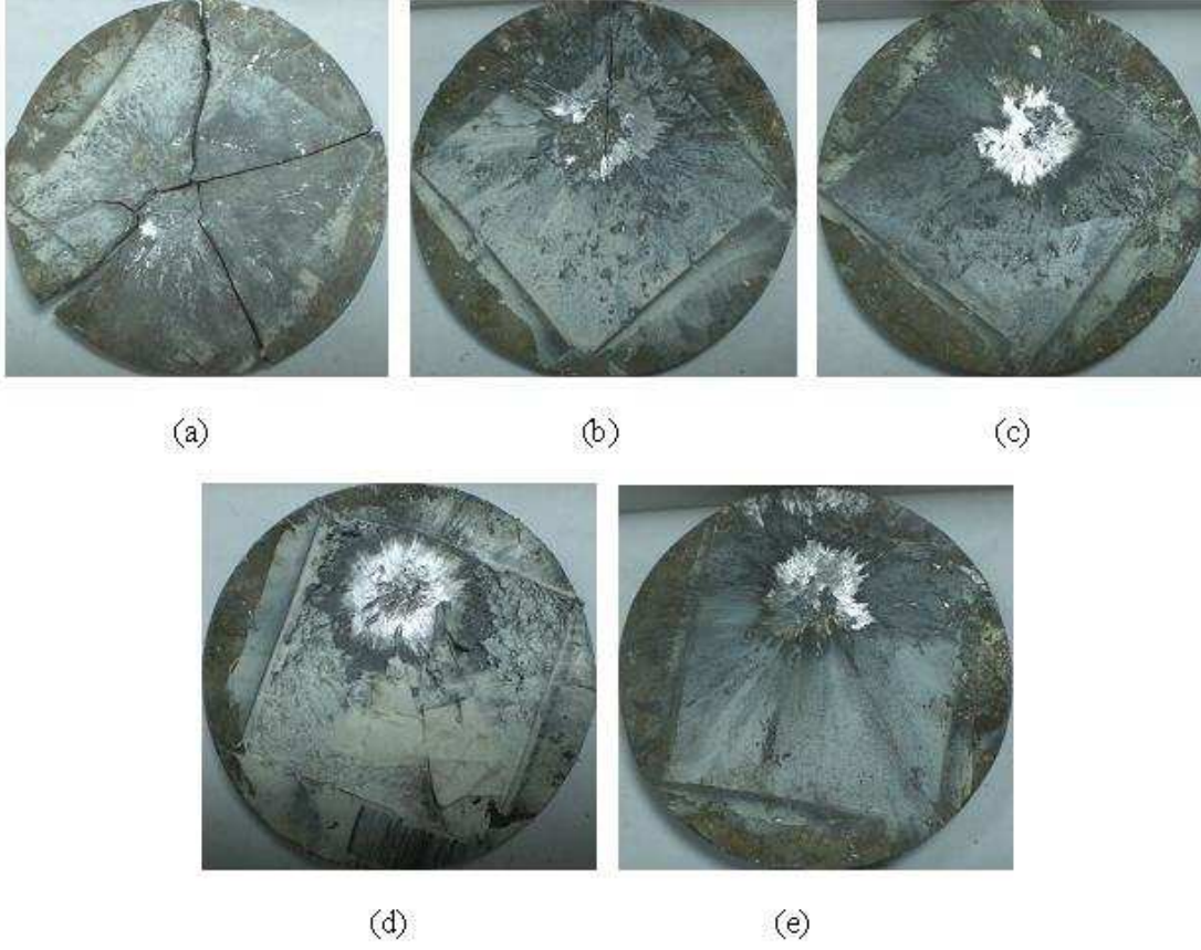
Şekil 5.3.25. 4D numunelerinin balistik deneyler sonrası ön yüz görüntüleri. 1.alan yoğunluğundan (a), 5.alan yoğunluğuna (e) kadar sıralanmış numuneler. 1. Alan yoğunluğunda delinmemiş ancak kırılmış numunenin resmi verilmiştir.
