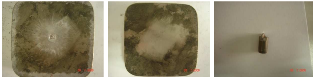
Şekil 5.3.6. 1D numunesinin 5. alan yoğunluğundaki deney sonrası görüntüsü. Numune kırılmamış ve delinmemiştir. Arka yüzünde çatlak oluşmazken (ortada), mermi çekirdeği parçalanmıştır (solda).
