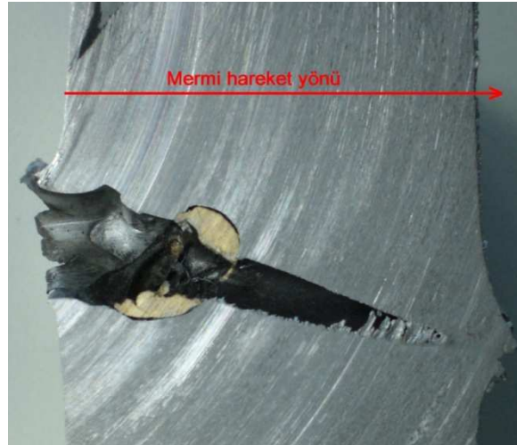
Şekil 5.4.5. Sünek alüminyum numunesi 6A’da mermi hareket yönünde bakır gömlek sıyrılması sonucu kesit daralması ve yine aynı nedenden mermi giriş bölgesindeki şişmenin gösterimi.
