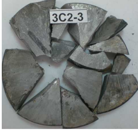
Şekil 5.4.6. 3C grubu numunelerde ani ve tahmin edilemez kırılma şeklinin gösterimi. Diğer modellerde gösterilenin dışında numune çok gevrek olduğu durumlarda mermi geçmesine izin vermese de kendisi parçalanarak dağılmaktadır.
