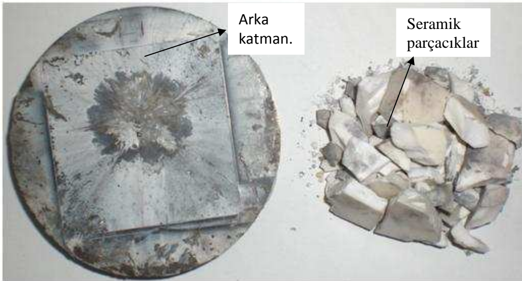
Şekil 5.3.21. Zırh delici mermi çarptıktan sonra katmanlı kompozit zırhın görüntüsü. Seramik katman parçalanıp destek katmandan ayrılırken destek katman balistik korumayı sağlamıştır.
