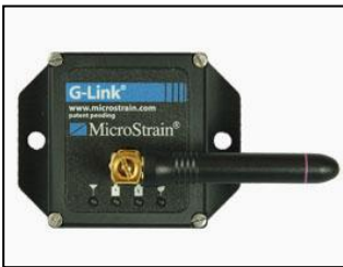
Şekil 24 – G-Link kablosuz ivmeölçer
