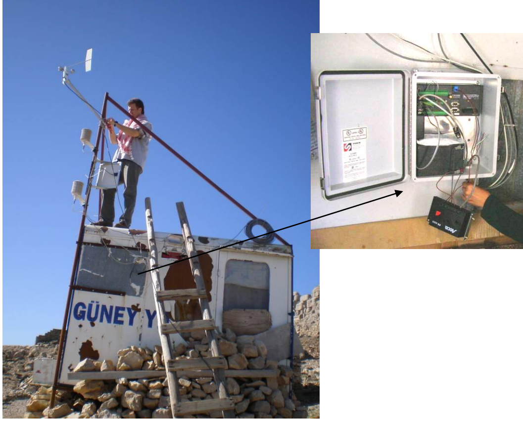
Şekil 19 – Rüzgar hız ve yön sensörü montajı ve programlaması
