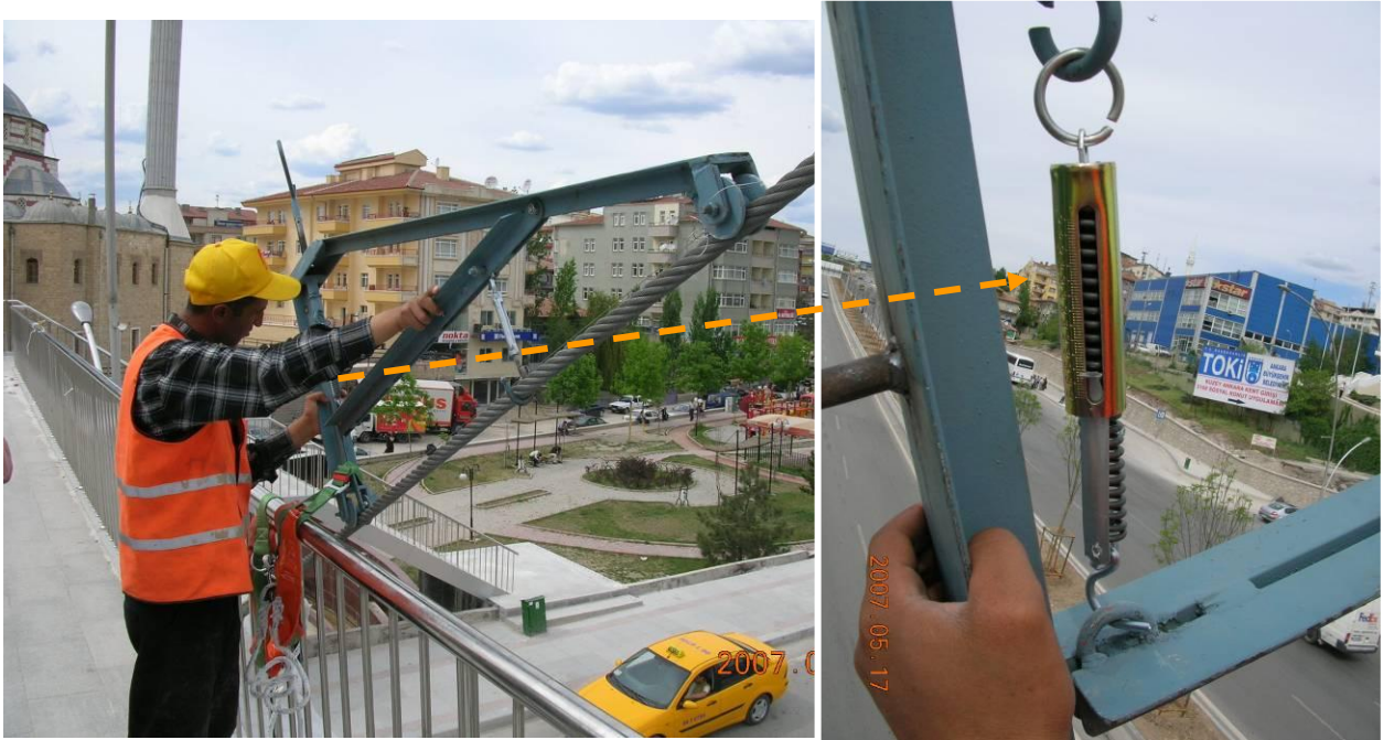
Şekil 67 – Kablo statik gergi ölçüm cihazı, ölçüm deneme çalışmaları.
