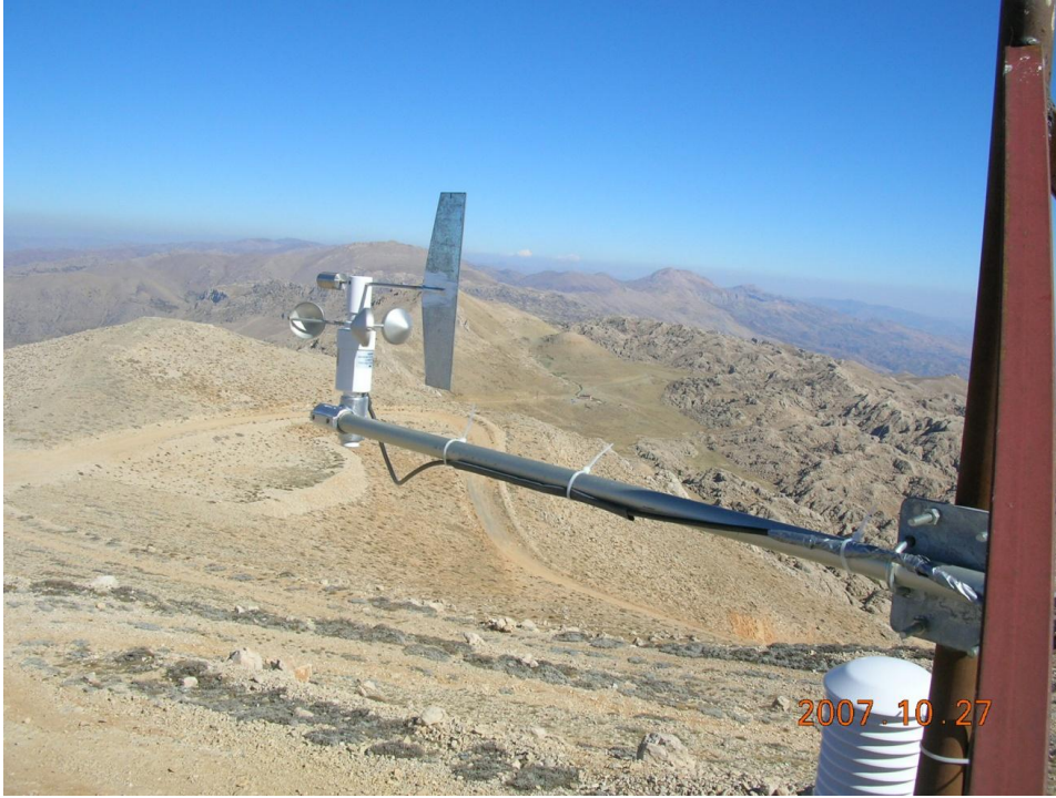
Şekil 41 – Tamir edilen rüzgar yön sensörünün yeni kuyruğu.
