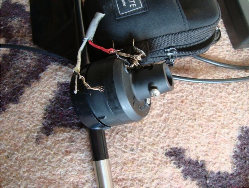
Şekil 50 – 220V AC elektriğe maruz kalarak yanan (yeni) rüzgar yön sensörü.
