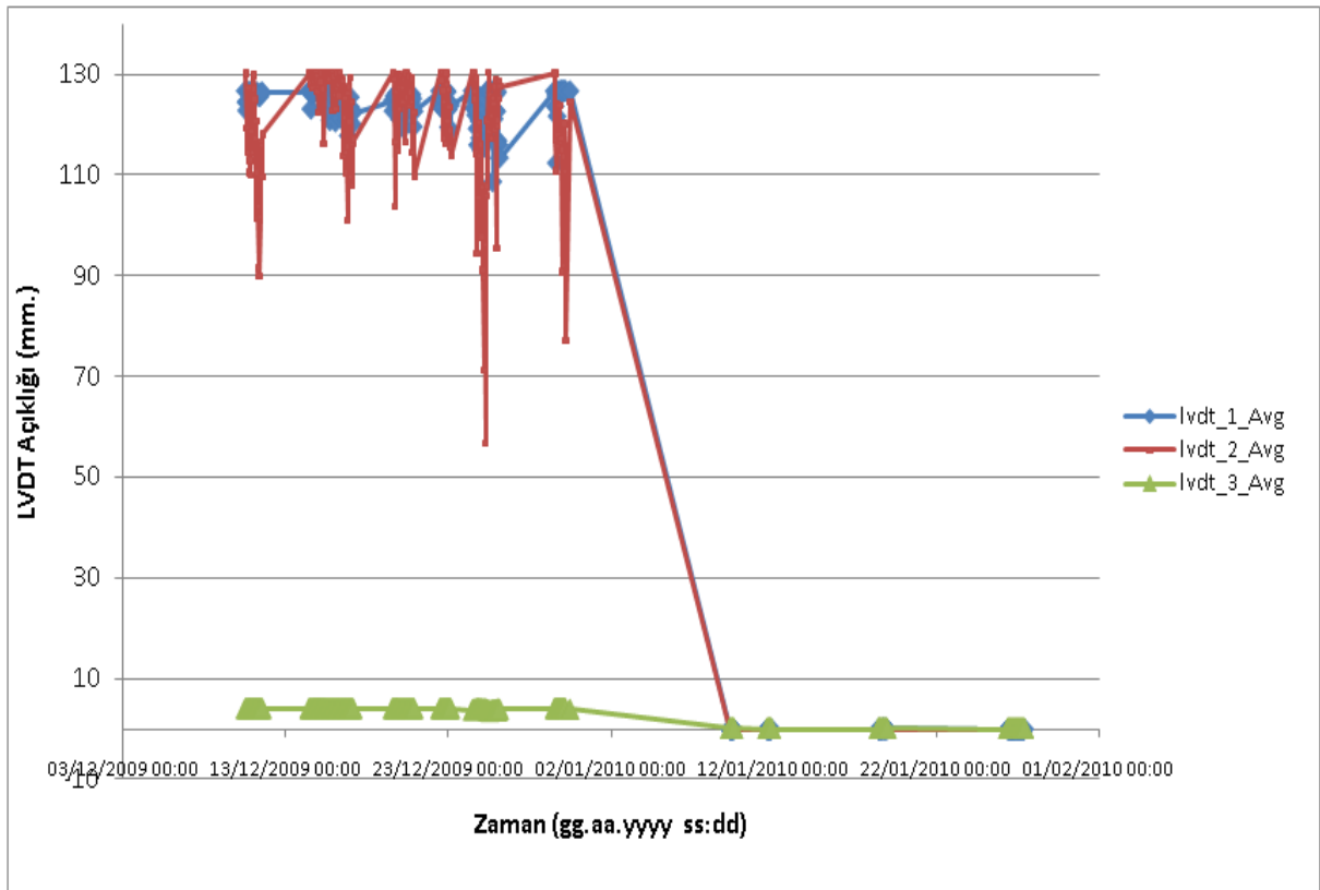
Şekil 116 – Lineer değişken deplasman ölçerlerden okunan değerler.
