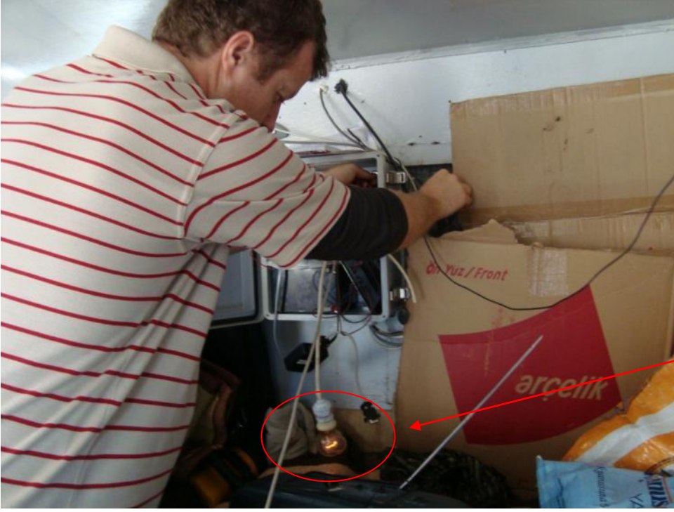
Şekil 49 – Veri toplama sistemi ile bekçi kulübesi duvarı arasında değdirildiğinde yanan 220V ampül.
