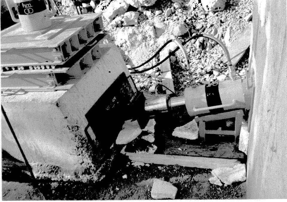
Şekil 3 Kesme Yükünün Numuneye Uygulanması
