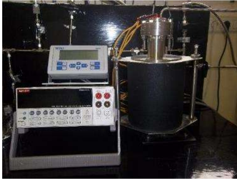
Şekil 3.6. Reaktör ve direnç ölçüm sisteminin genel görünümü.
