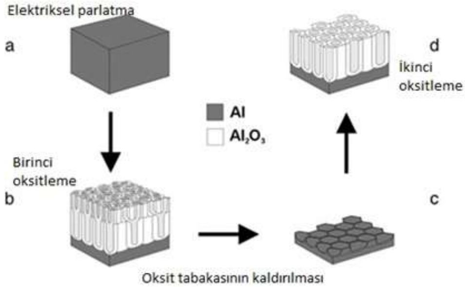
Şekil 4-1.17. Elektriksel oksitleme yönteminin basamakları ve deney sonucu oluşan ucu kapalı gözenekler ile kalıntı alüminyum tabakasının görünümü (Marsal vd. 2012).
