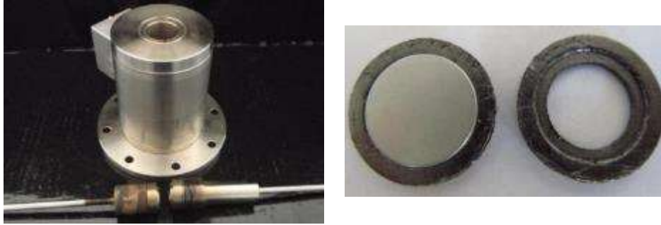
Şekil 3.11. (a) Test haznesinin ve (b) kullanılan grafit contanın görünümü.
