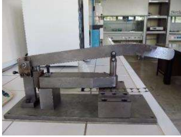
Şekil 4.1.21. Metalik folyodan 19 mm' lik disklerin çıkartılması amacıyla kullanılan delgi cihazı.
